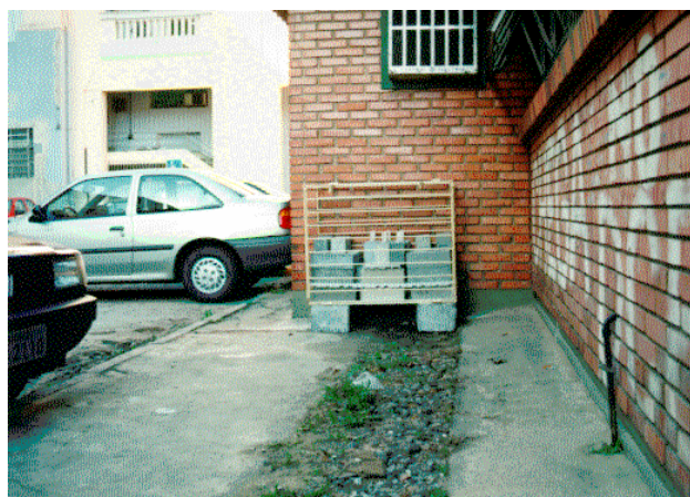
Figura 22: corpos-de-prova em ambiente natural de degradação – estacionamento da Escola de Engenharia/UFRGS
