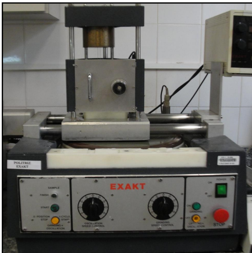
Figura 18- Politriz metalográfica Exakt (Nordestedt, Schleswing-Holstein, Alemanha) promovia o lixamento e o polimento gradual da peça até atingir 30 micrômetros de espessura.
