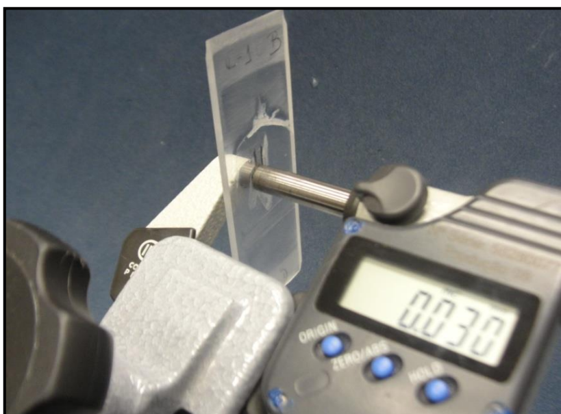
Figura 19- Mensuração da lâmina em um micrômetro de precisão. Verifica-se que a espessura obtida foi de 30 micrômetros.
