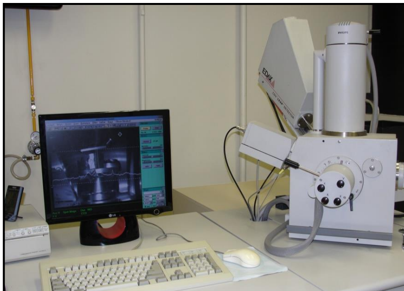
Figura 27- Microscópio Eletrônico de Varredura Philips (modelo XL 30 FEG EDX. Eindhoven, Holanda)
