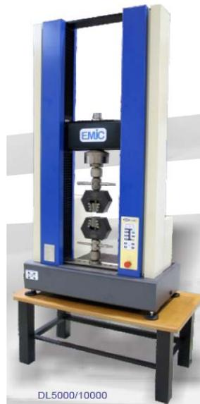
Figura 3.2 Máquina de ensaio de tração uniaxial EMIC 10.000.
