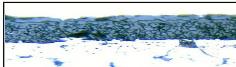
Figura 4.27 Camada de óxidos da amostra 9 (ampliação 1000x).
