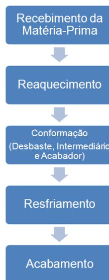
Figura 2.9 Representação esquemática do fluxo do processo de laminação.
