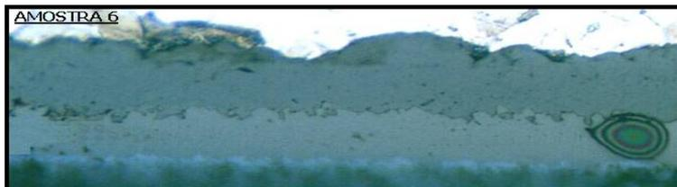
Figura 4.17 Camada de óxidos da amostra 6 (ampliação 1000x).
