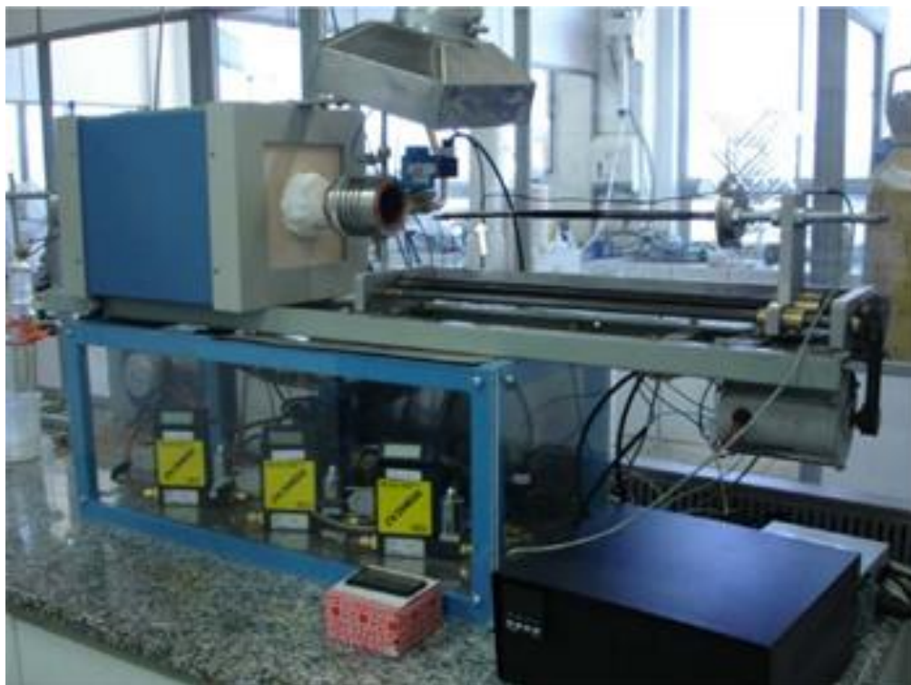
Figura 5.3. Reator de leito horizontal para CVD utilizado na síntese de nanoestruturas.
