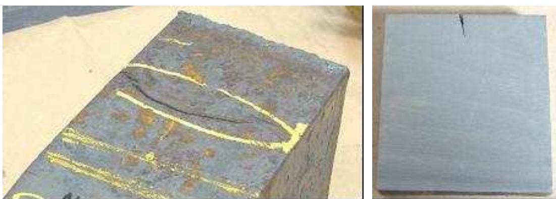
Figura 18: Trinca transversal em tarugo de aço 1025. Espessura da trinca: 1,70mm Profundidade da trinca: 16,87mm
