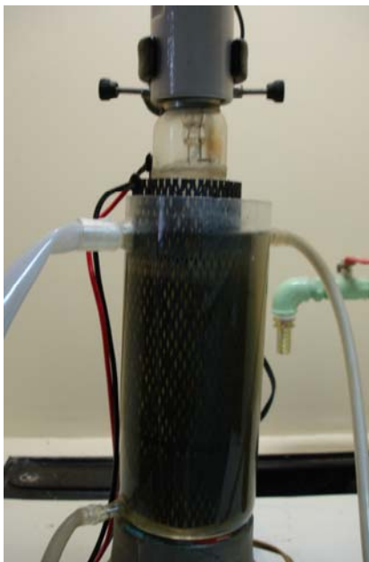
Figura 17: Foto-reator utilizado nos ensaios de otimização do processo de FEO.
