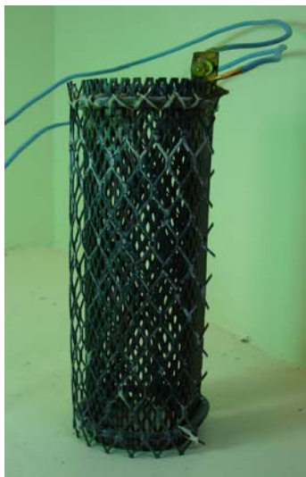
Figura 9: Par de eletrodos, cátodo externo e ânodo interno. Ânodos revestidos com uma mistura de óxidos de titânio e rutênio, na proporção 70\text{TiO}_2/30\text{RuO}_2 , da marca De Nora do Brasil®, e cátodos revestidos de \text{TiO}_2 .
