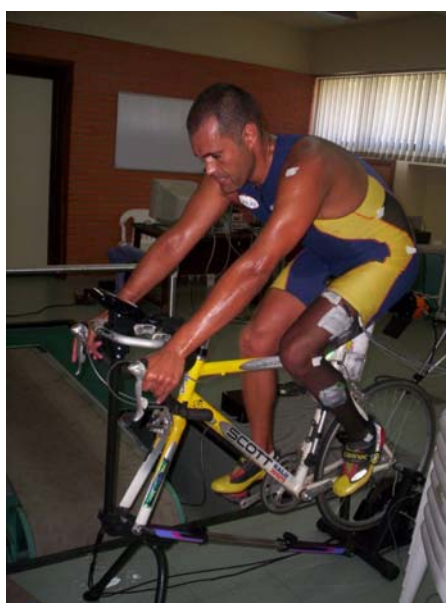
Figura 2. Utilização do ciclo simulador, adaptado à própria bicicleta de um atleta.
