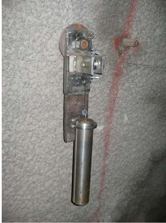
Figura 7.13: Sistema alternativo de medição de deslocamentos, instalado
