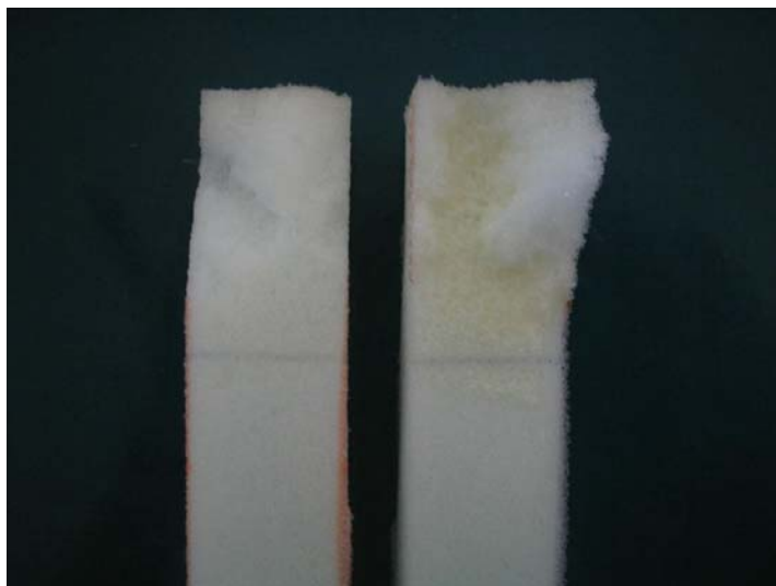
Figura 33: Fotografia do corpo de prova de espuma com situação mista de falha adesiva e ruptura do material após ensaio de descascamento
