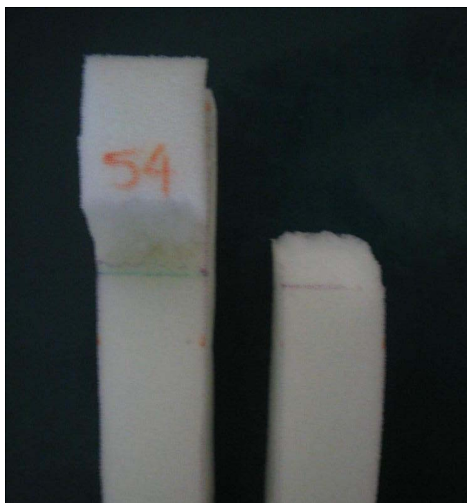
Figura 32: Fotografia do corpo de prova após ensaio de descascamento com ruptura da espuma
