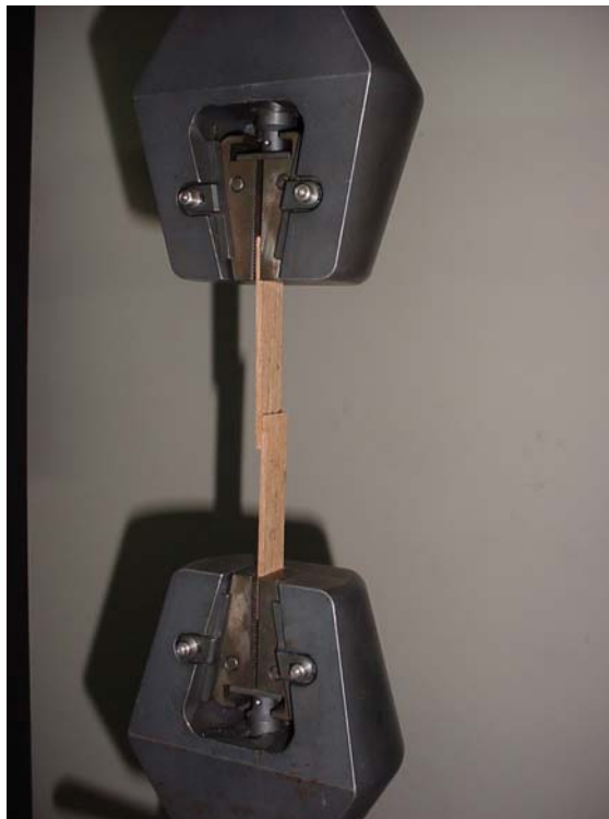
Figura 11: Fotografia do corpo de prova de madeira em ensaio de resistência ao cisalhamento
