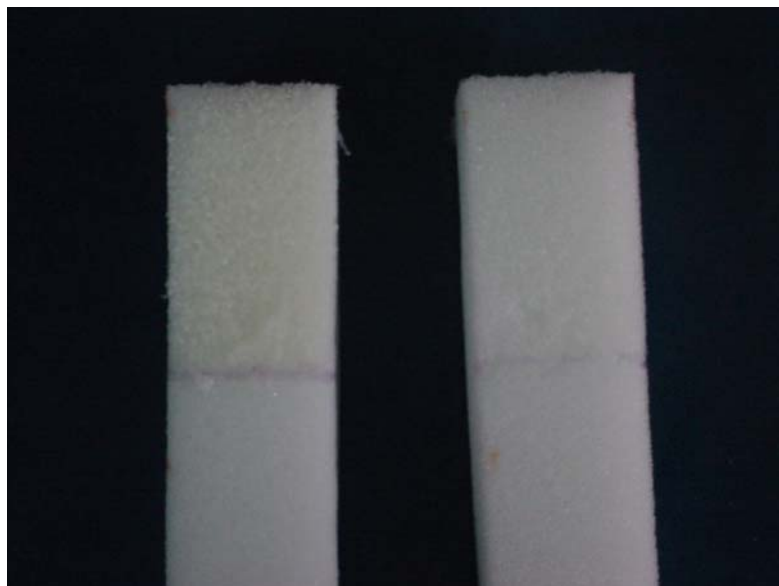
Figura 31: Fotografia após ensaio de descascamento de corpo de prova de espuma (unido por adesivo PU1-0,8) com falha adesiva
