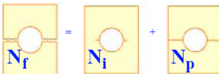
Figura 2.5. Formulação de vida em fadiga ilustrada (fonte: MSC.SOFTWARE CORPORATION, 2001-A)
