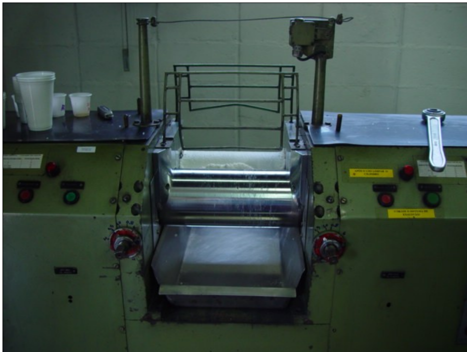
Figura 11: Misturador aberto ou de cilindros (CETEPO/SENAI).
