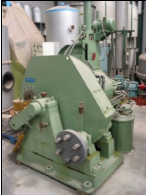
Figura 5: Misturador fechado ou Banbury.
