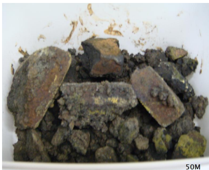
Figura 43. Matriz de argamassa com 50 % de metal ao ser retirada do molde após a cura em câmara úmida.
