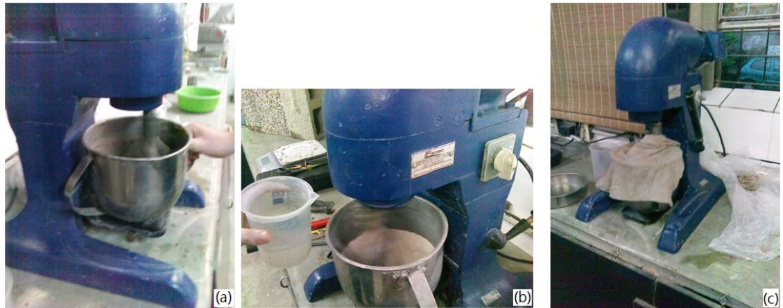
Figura 5. Ensaio de água de consistência, em: (a) argamassadeira, (b) adição de água ao cimento e metal e (c) período de repouso.
