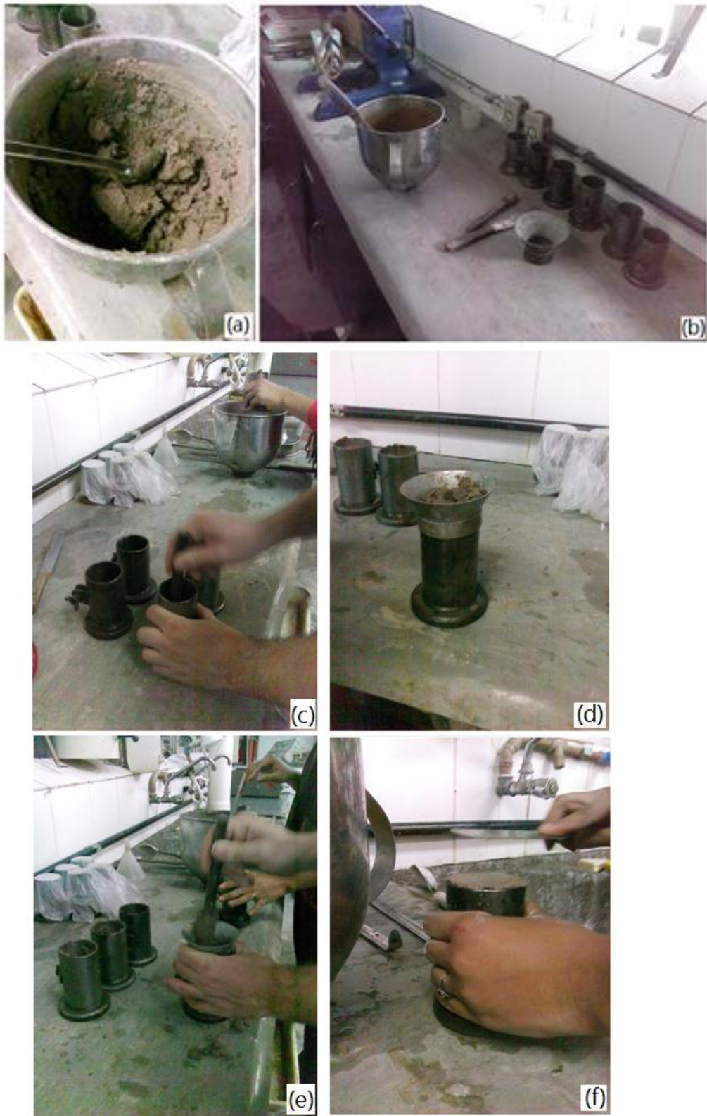
Figura 3: Moldagem das matrizes em: (a) argamassa pronta, (b) material necessário ao ensaio, (c) (d) (e) (f) etapas da moldagem.
