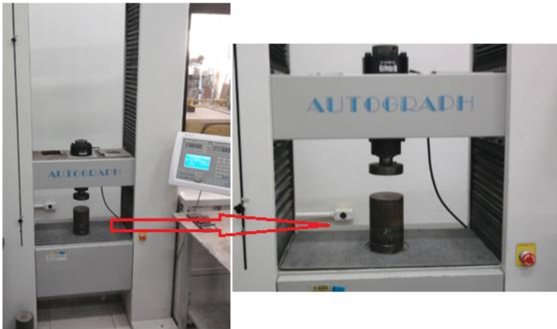
Figura 11. Prensa utilizada para ensaios de resistência à tração na flexão e à compressão.
