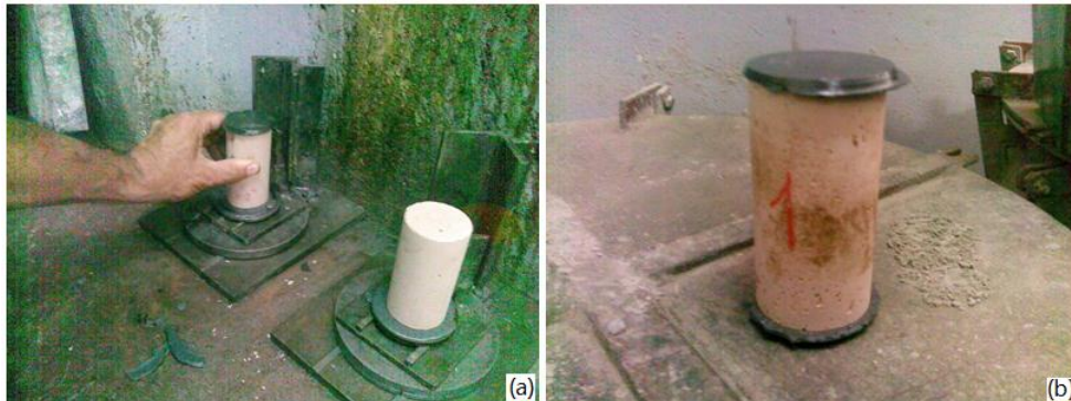
Figura 8. Capeamento das matrizes para ensaio de resistência à compressão axial.
