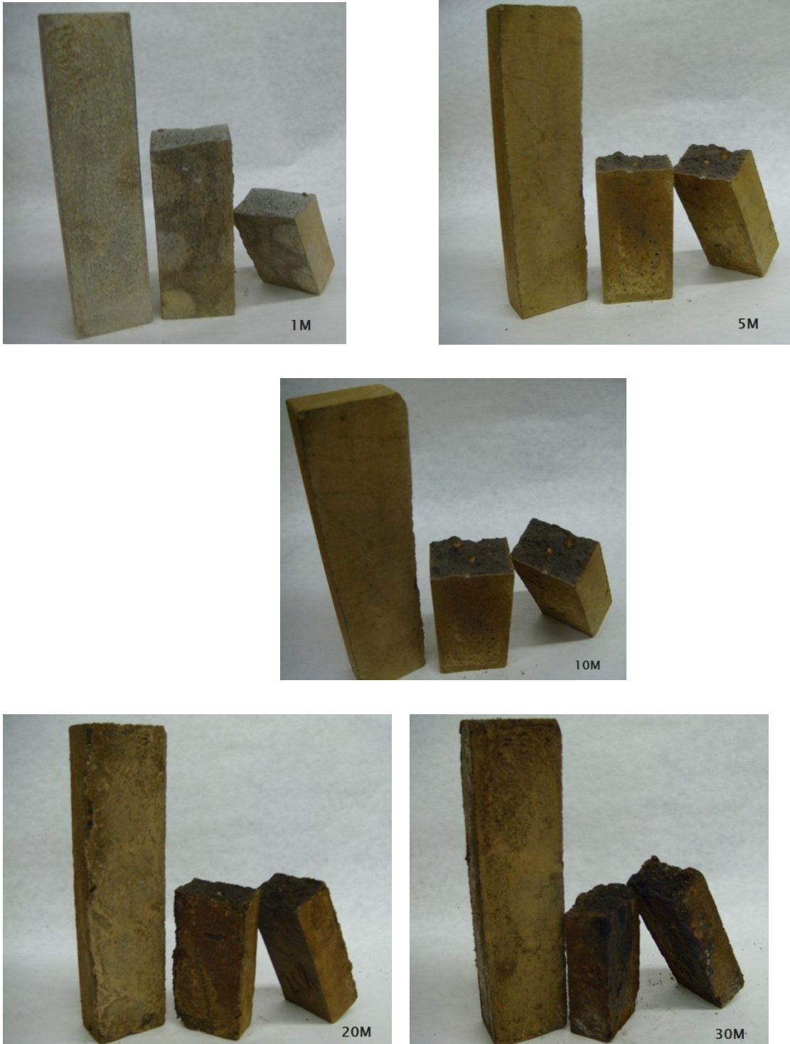
Figura 42. Faces externa e interna (após a ruptura) de matrizes de argamassa contendo 1 a 30 % de metal.
