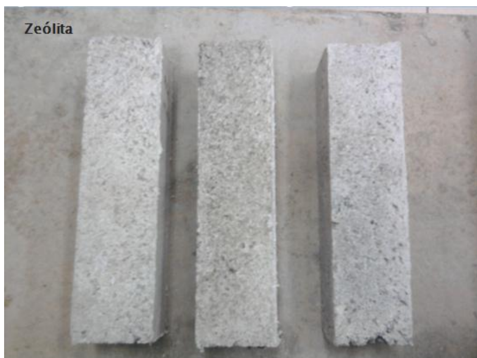
Figura 30. Matrizes com zeólita adicionada moldados para avaliação de resistência à flexão e na compressão.
