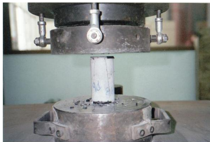
Figura 9. Matriz de argamassa após a ruptura na prensa: ensaio de compressão axial.
