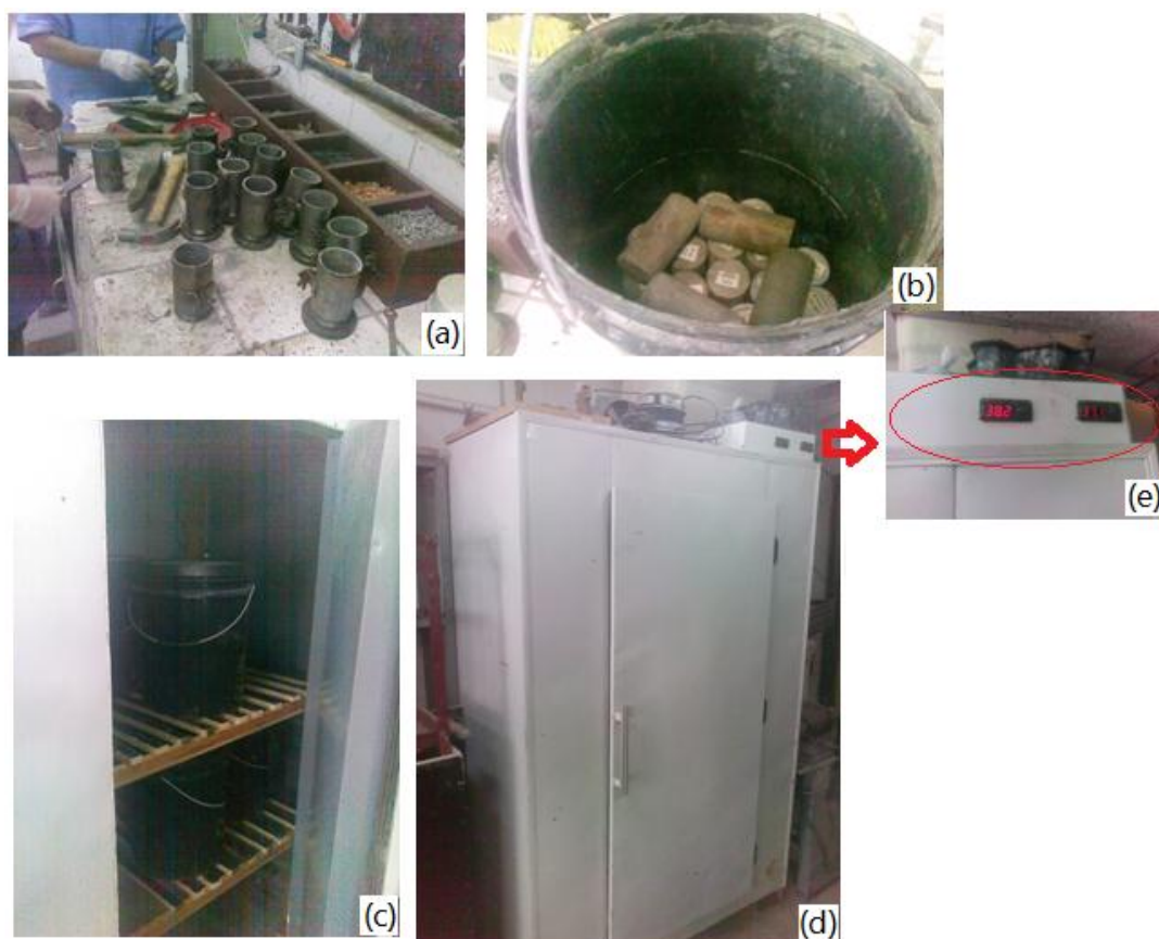
Figura 4. Etapas de retirada dos moldes e continuidade da cura em câmara climatizada das matrizes. Em: (a) retirada do molde, (b), (c) e (d) armazenamento.
