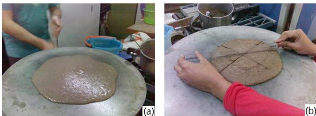
Figura 6. Ensaio de água de consistência, em: (a) argamassa espalhada sobre a mesa de consistência, (b) medida do comprimento de argamassa espalhada.
