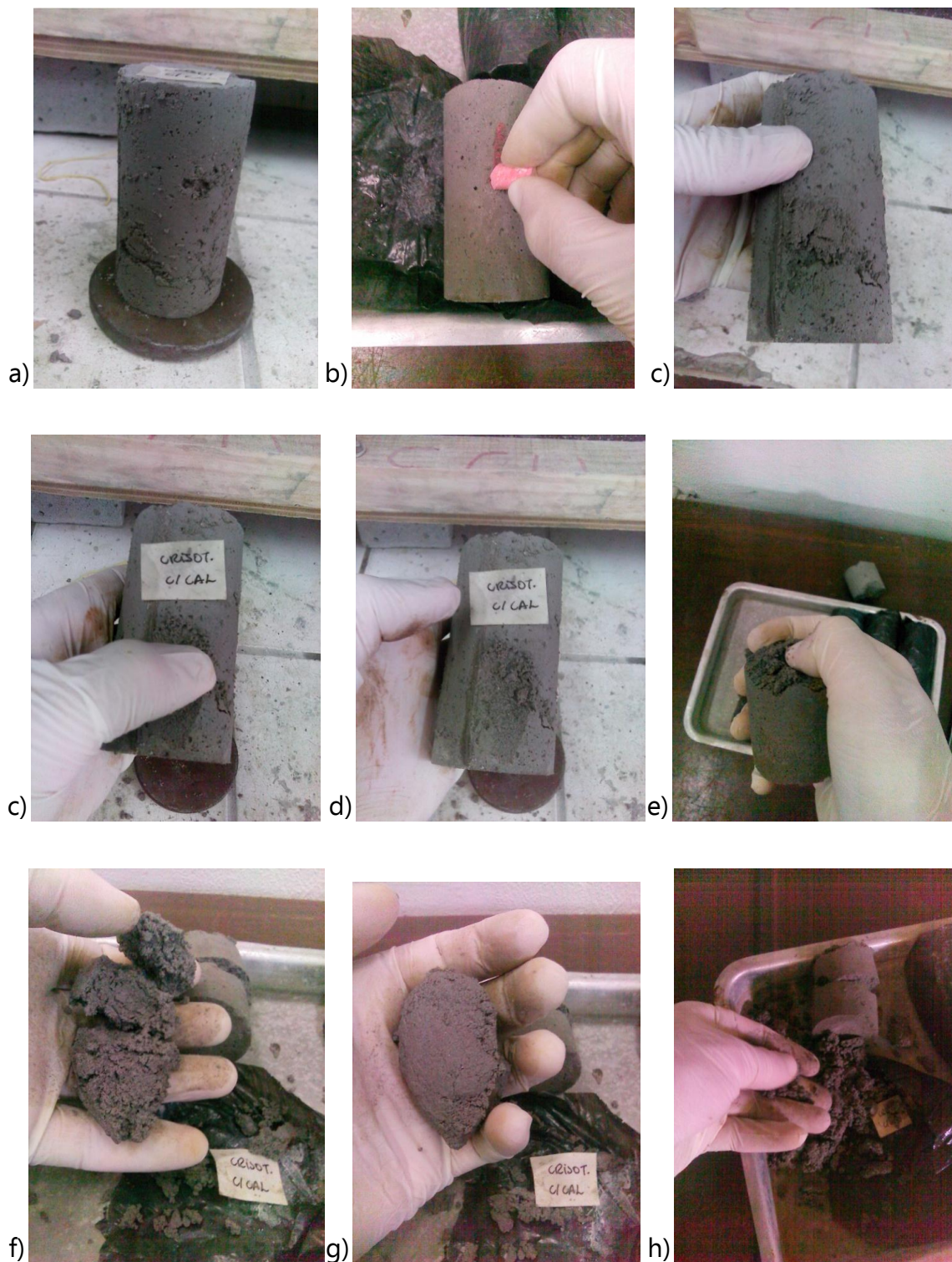
Figura 78. Matrizes após a retirada do molde (a), menos resistente que o giz (b); nas imagens (c),(d),(e),(f),(g) e (h): não desenvolveram resistência no ensaio de atividade pozolânica.
