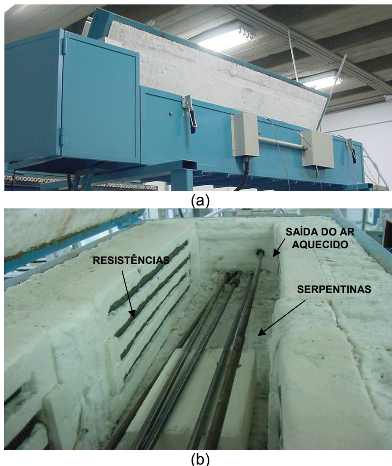
Figura 5.13. Sistema de pré-aquecimento do ar comprimido do aparato de desgaste erosivo (a) vista externa do forno elétrico, (b) vista interna do forno elétrico e, visualização das serpentinas.
