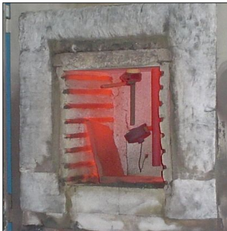
Figura 5.22. Exemplo de ensaio de desgaste erosivo com fluxo de erodente atingindo a amostra em 60^\circ e temperatura de 600^\circ\text{C} .
