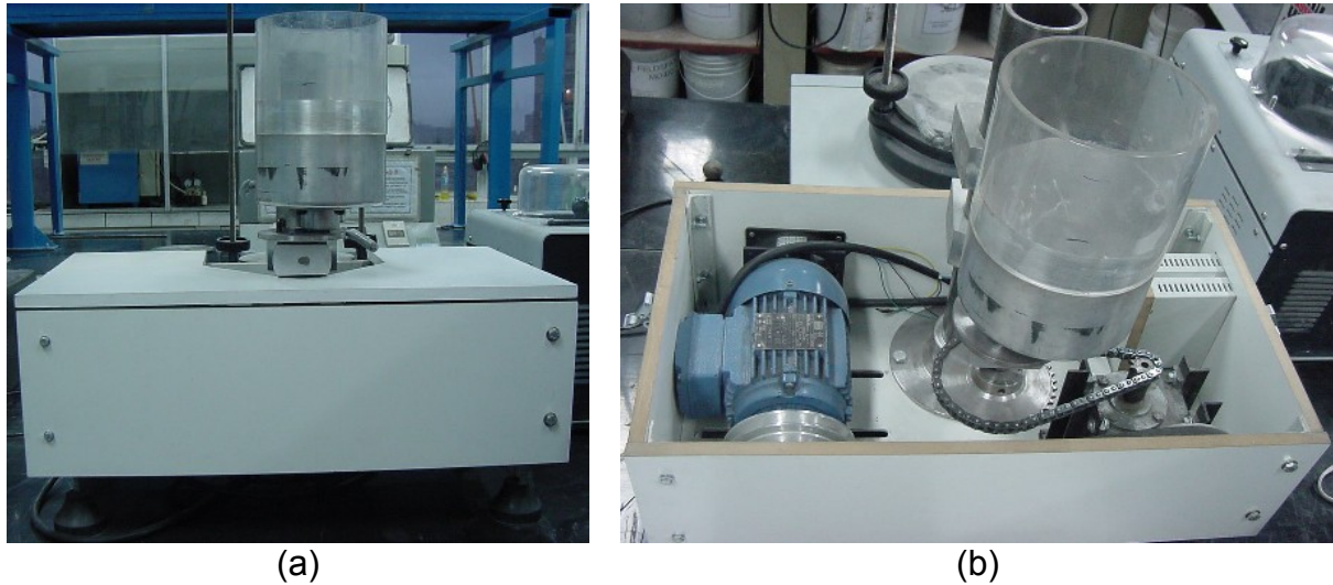
Figura 5.16. Sistema alimentador de partículas do aparato de desgaste erosivo (a) vista externa, (b) vista interna.
