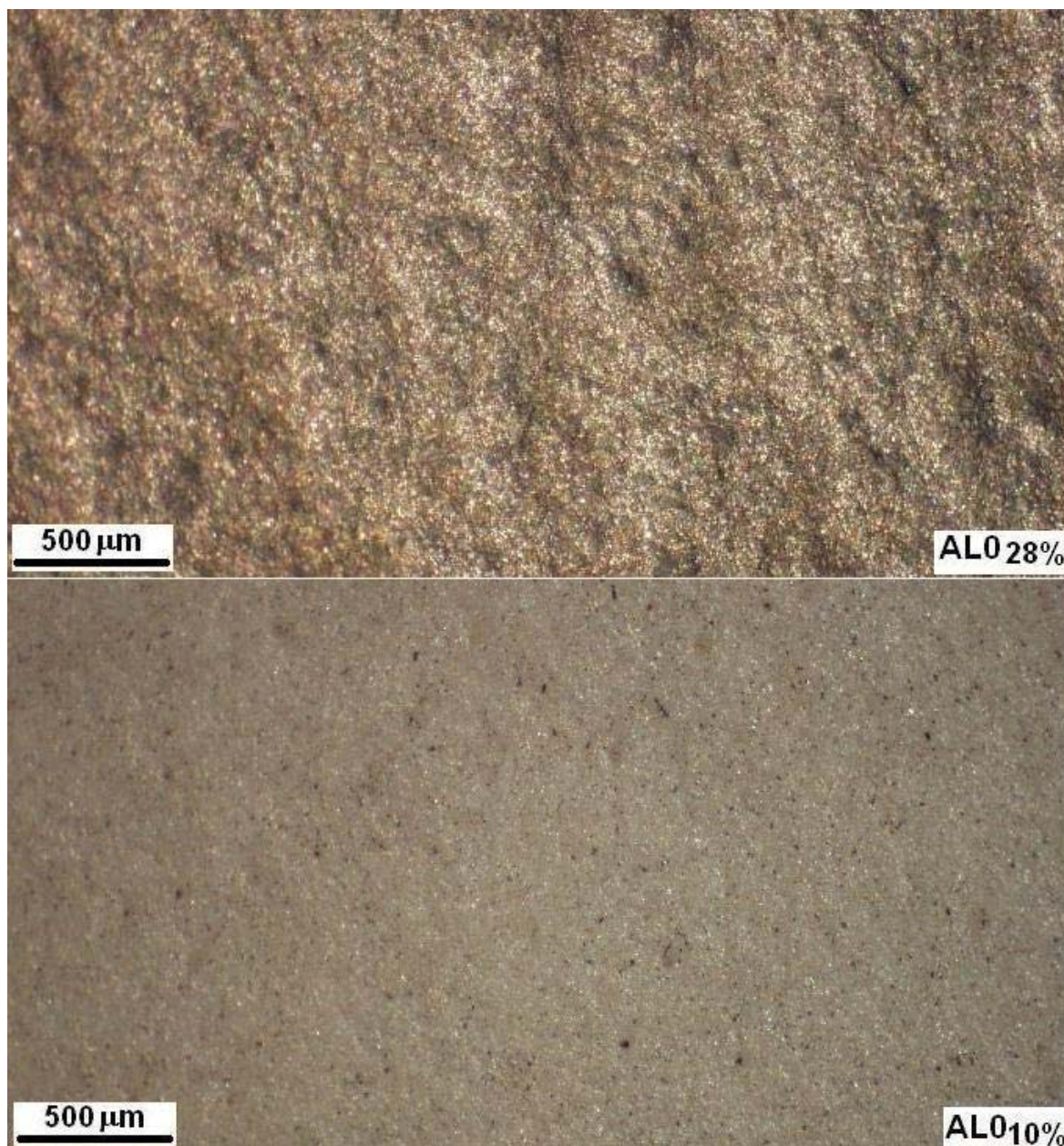
Figura 6.9. Micrografias da superfície alumina ALO_{28\%} e ALO_{10\%} após erosão a 800^{\circ}C com ângulo de ataque de 30^{\circ} . A imagem foi obtida por microscopia óptica em aumento de 40 vezes.
