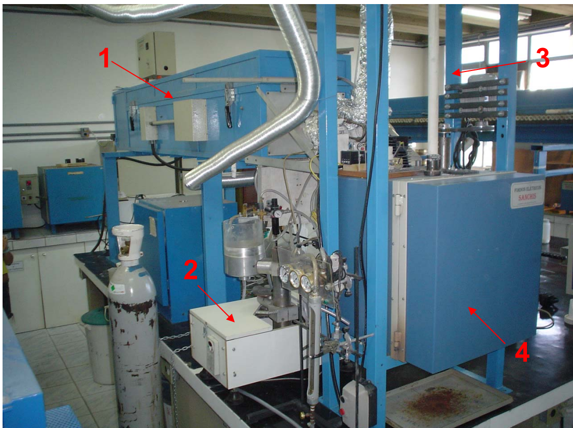
Figura 5.12. Equipamento para ensaios de desgaste erosivo indicando as partes principais: (1) sistema de pré-aquecimento do ar, (2) sistema de alimentação de partículas erodentes; (3) Sistema venturi-acelerador de partículas e (4) Forno para os ensaios.
