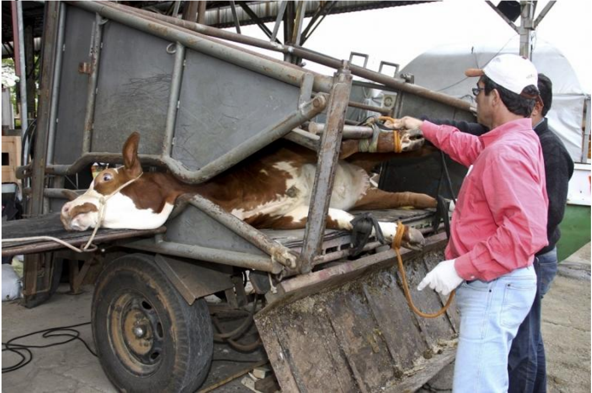
Figura 26 - Tronco hidráulico de tombamento lateral
