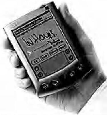
FIGURA 2.12 - Dispositivo de análise dinâmica de assinaturas.
