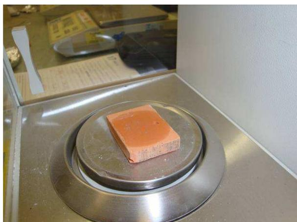
Etapa 5: pesagem da unidade cerâmica após "n" minutos de contato com argamassa
