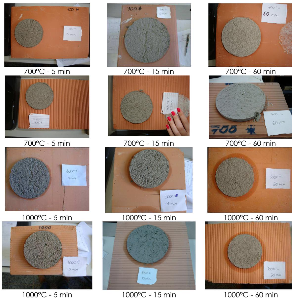
Figura 52: imagens das argamassas moldadas sobre os blocos cerâmicos, em diferentes tempos, antes dos ensaios de *squeeze flow*.
