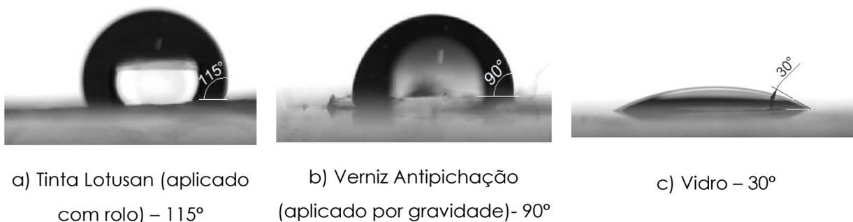
Figura 4: medição de ângulos de contato (adaptado de FLORES ET AL., 2012)
