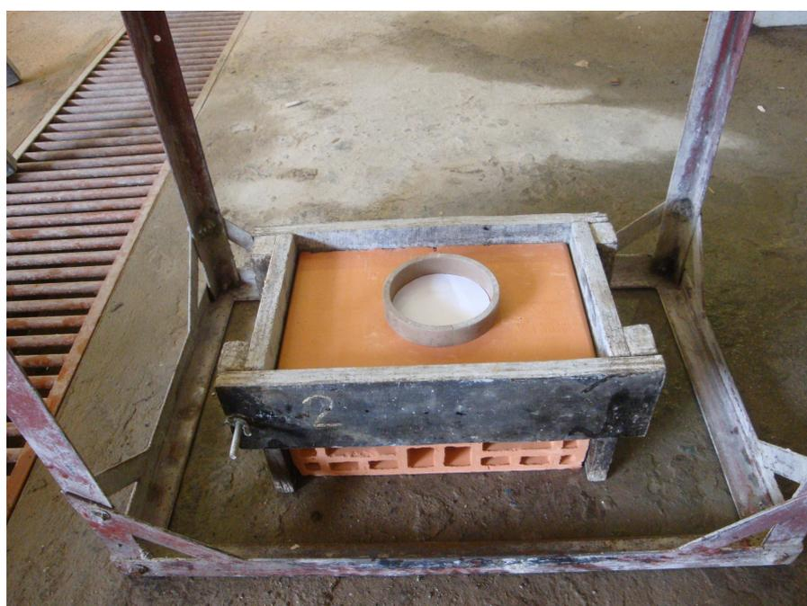
Figura 21: detalhe do recipiente utilizado no ensaio de densidade de massa no estado fresco na caixa de queda
