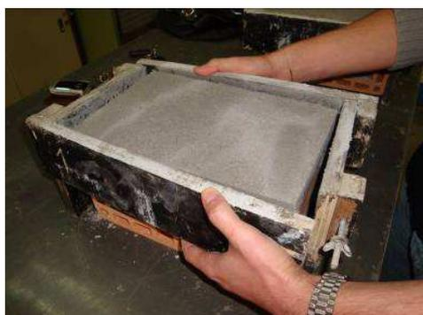
Retirada da forma após 24 hrs
