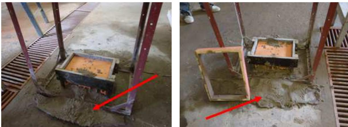
Figura 19: detalhe do molde utilizado para colocação da argamassa sobre o alçapão da caixa de queda e detalhe da argamassa projetada para fora da superfície de contato com o bloco.
