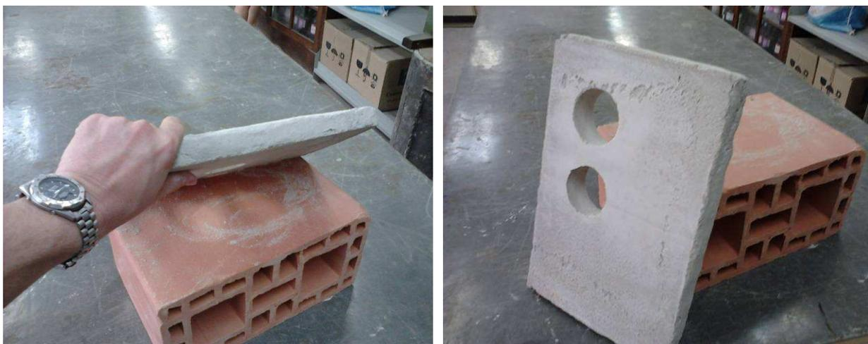
Figura 32: detalhe do revestimento deslocado após selamento dos poros com parafina.
