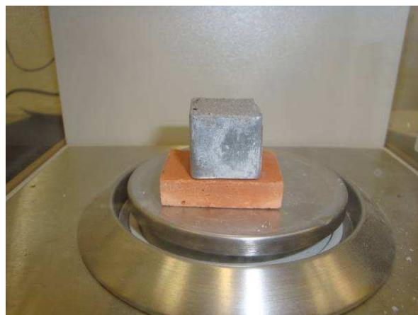
Etapa 4: Moldagem e pesagem do conjunto cerâmica+argamassa+molde
