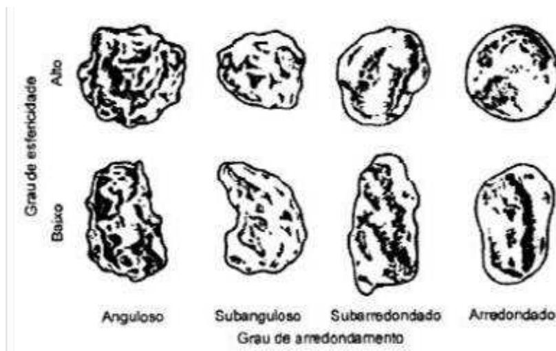
Figura 6: classes de arredondamento ( NBR 7389/92).
