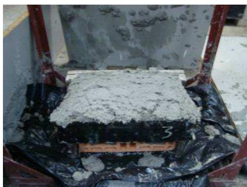
Moldagem dos revestimentos
