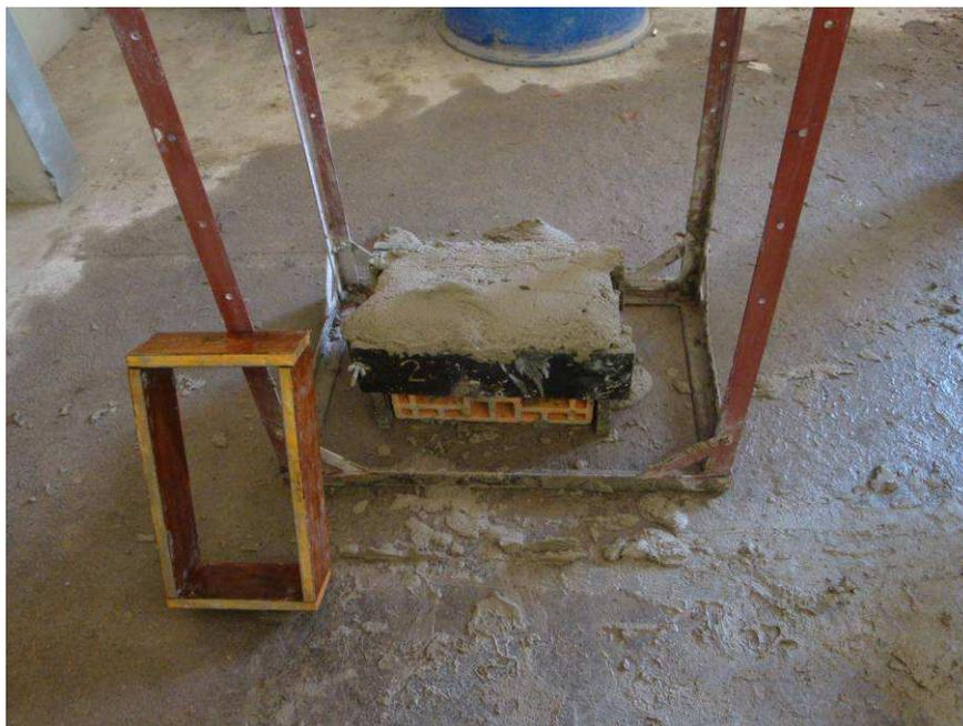
Figura 20: molde final utilizado para colocação da argamassa sobre o alçapão da caixa de queda. Note-se também o menor desperdício de argamassa e o preenchimento homogêneo da face do bloco.
