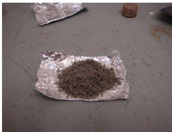
Etapa 6: pesagem da argamassa retirada de cima da superfície cerâmica
