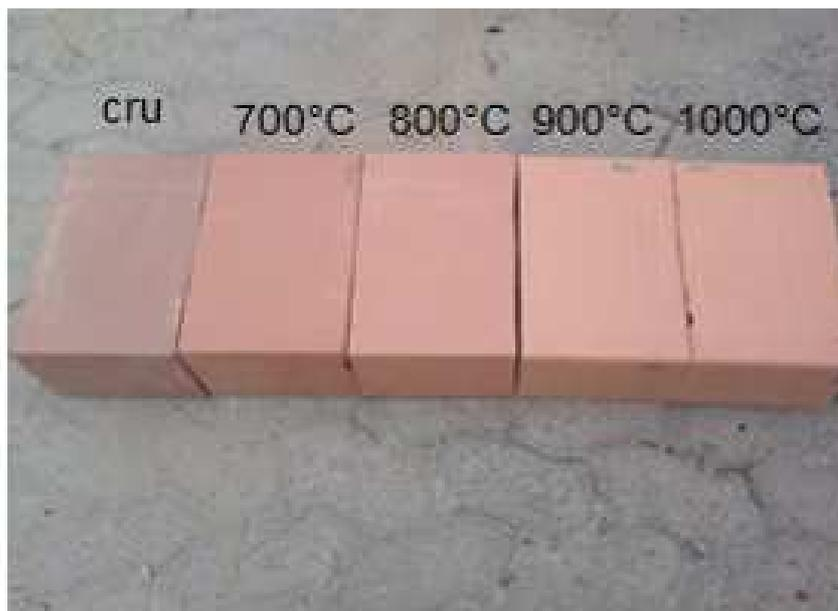
Figura 17: aspecto visual dos blocos cerâmicos submetidos à queima em laboratório com diferentes temperaturas.
