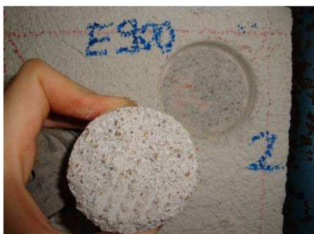
Registro fotográfico da amostra após a execução do ensaio de tração
