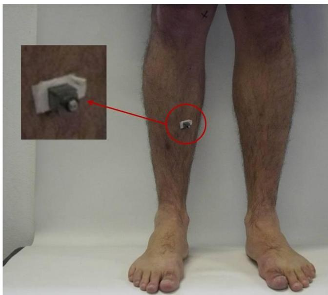
**Figura 19.** Fixação do acelerômetro com madeira balsa.
