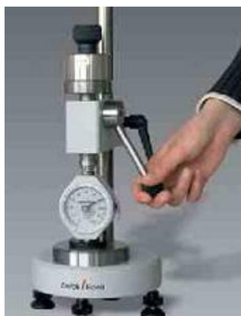
**Figura 12.** Durômetro de bancada - modelo Zwick 7206.
