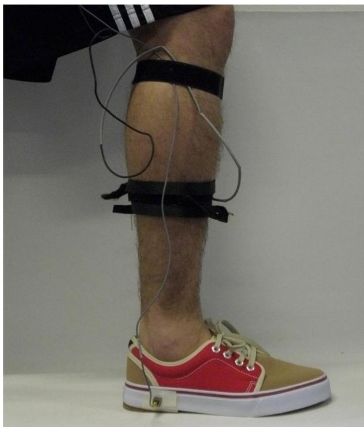
**Figura 21.** Fixação do acelerômetro na região lateral do calçado.
