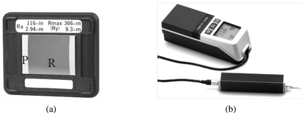
Figura 4.8: Rugosímetro Mitutoyo SurfTest SJ-201: (a) padrão de calibração/aferição, a região marcada com “P” é polida; a região marcada com “R” é rugosa; (b) equipamento de medição
