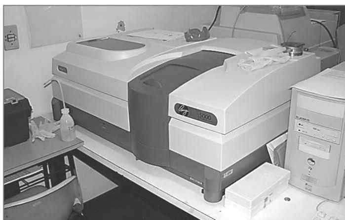
Figura 5.2: Espectrofotômetro CARY5000
