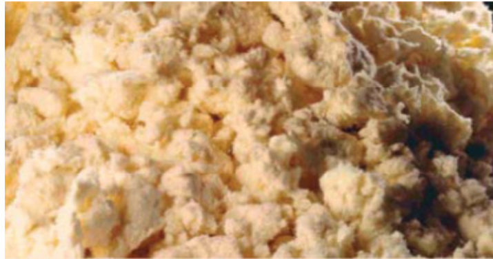
Figura 8: Fibra aramida dispersa no elastômero – Rhenogran® P91-40/NBR [8].
