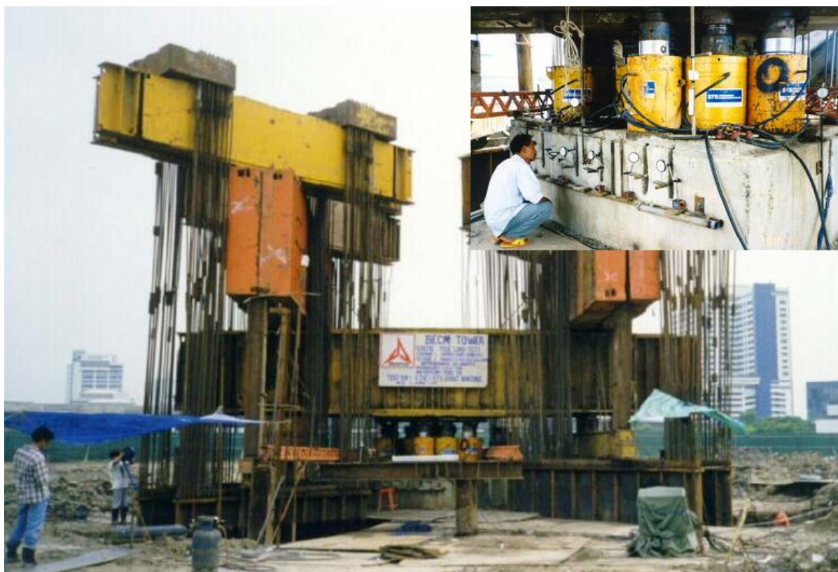
Figura 12 – quadro de reação com capacidade para 60.000 kN (fonte: modificado de THASNANIPAN et al., 1999)
