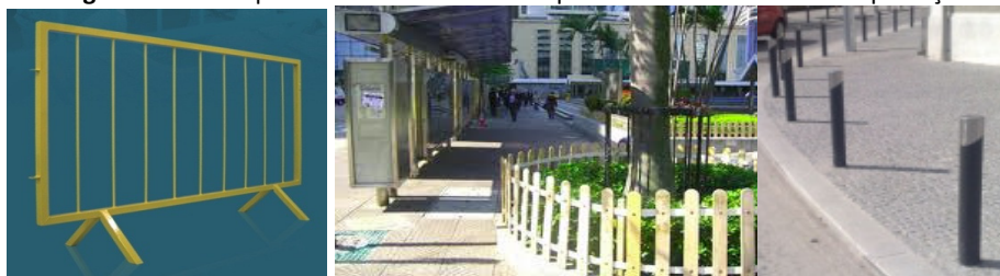
Figura 34 – Exemplos de mobiliário urbano que constituem barreiras de proteção
