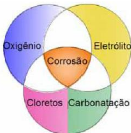
Figura 4 – Condições para ocorrência da corrosão
