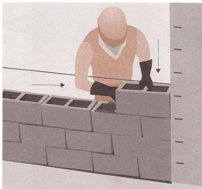
Figura 8 – Assentamento de blocos junto a pilares
