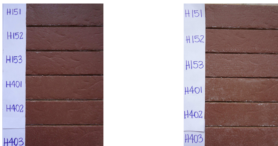
Figura 30: Placas tratadas com hidrofugante: (a) antes do rejuntamento; (b) após rejuntamento e limpeza
