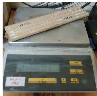
Figura 24 – Medição da massa das placas
