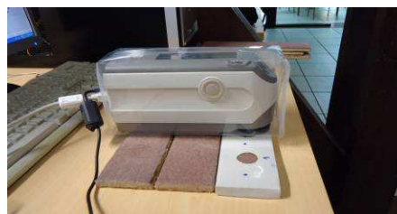
Figura 19 – Vista geral da realização do ensaio com espectrofotômetro
