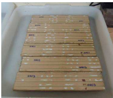
Figura 23 – Placas em contato com lâmina de água
