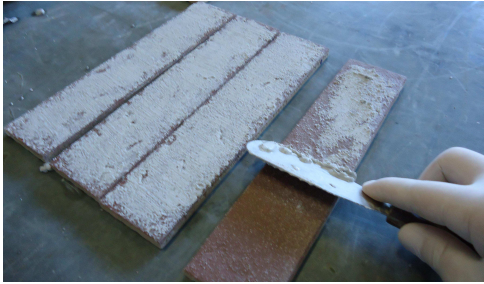
Figura 21 – Manchamento da superfície da placa cerâmica com argamassa de rejuntamento
