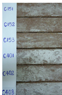
Figura 20 – Aspecto da aplicação de cera com pano e sem polimento
