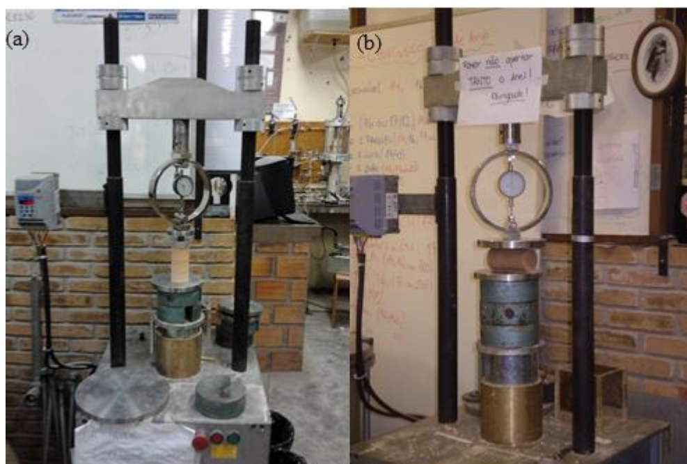
Figura 20 – (a) ensaio de compressão simples e (b) diametral
