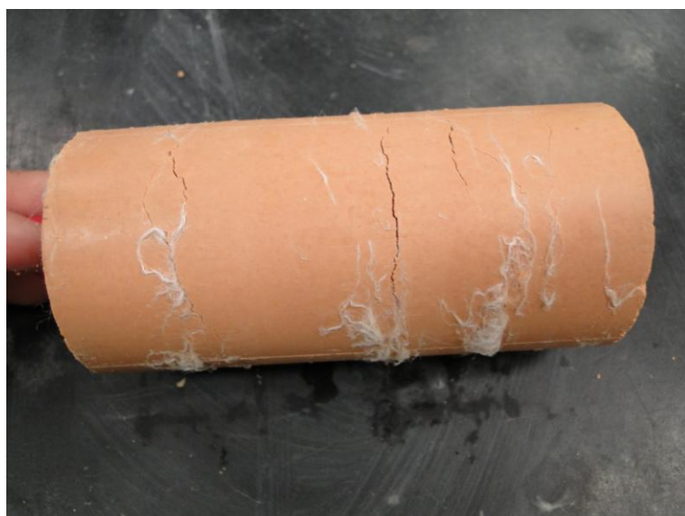
Figura 27 – Modo de ruptura de misturas solo-cal-fibra de polipropileno quando submetido à compressão diametral
