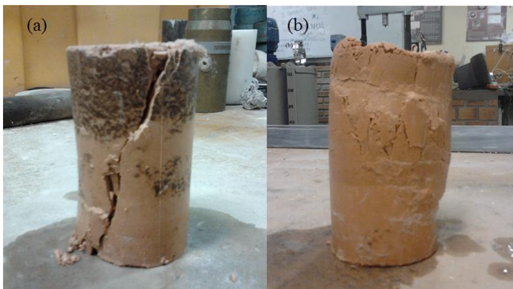
Figura 38 – Modos de ruptura (a) caulim-cal e (b) caulim-cal-fibras de polipropileno
