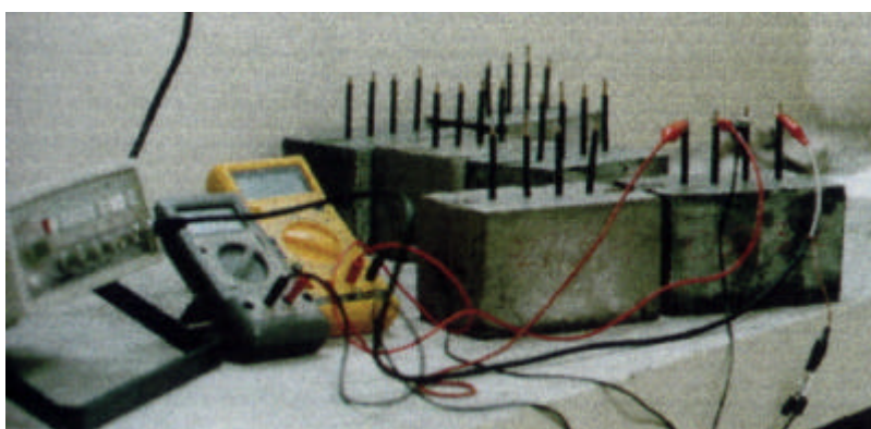
Figura 10 – Ensaio de medição de resistividade (ABREU, 1998)
