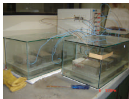
b) Ensaio CAIM nos cps com a/c 0,5 e 0,7.
