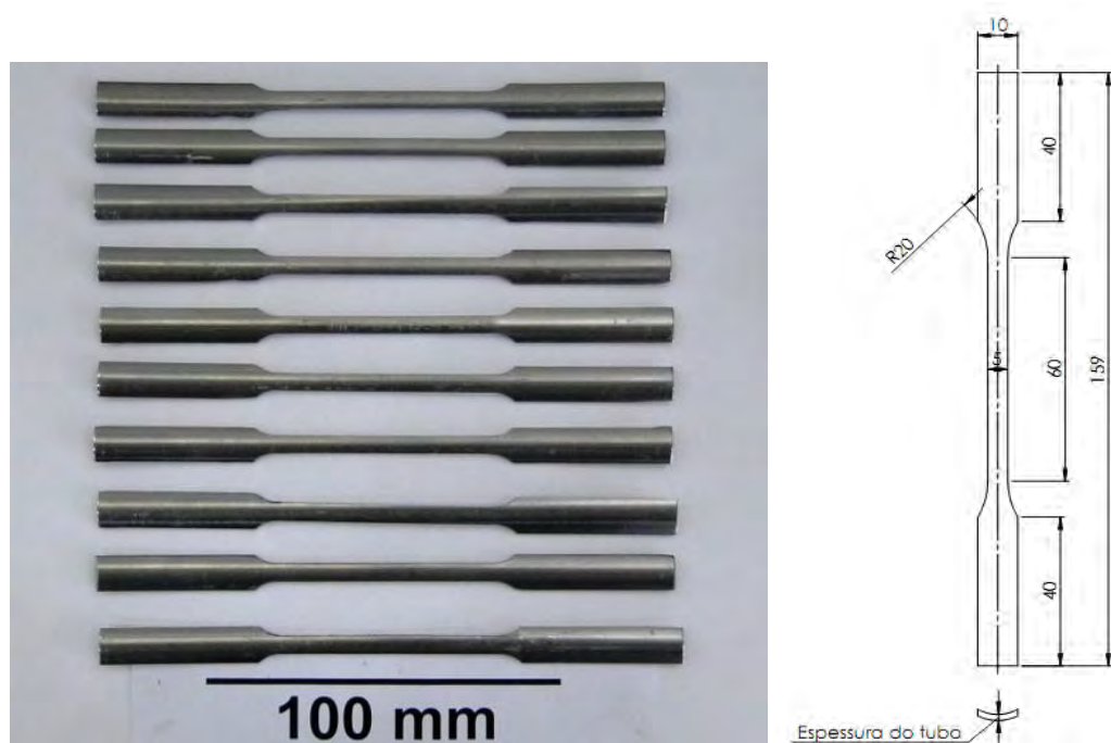
Figura 2. Corpos de prova (esquerda) e dimensões em milímetros (direita).
