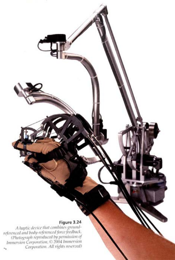
Imagem 27 - Estrutura mecânica para a captura do movimento da mão. (Fonte: BOWMAN, Doug A. et alí. 3D user interfaces, theory and practice. Boston MA: Ed. Pearson Ed., 2005.)
