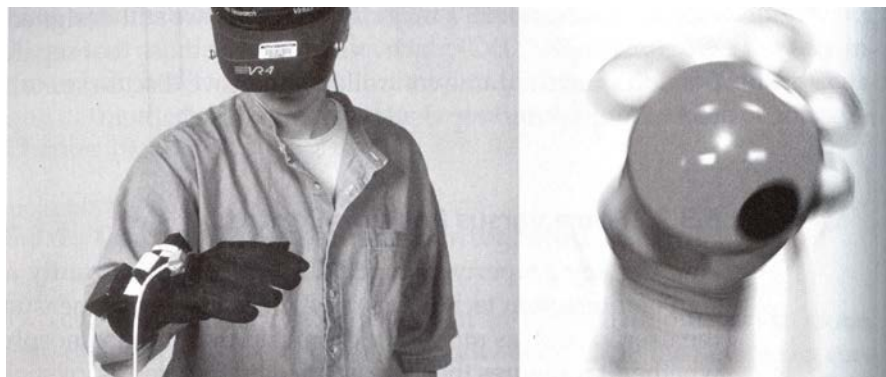
Imagem 28 - Data glove. (Fonte: BOWMAN, Doug A. et ali. 3D user interfaces, theory and practice. Boston MA: Ed. Pearson Ed., 2005).
