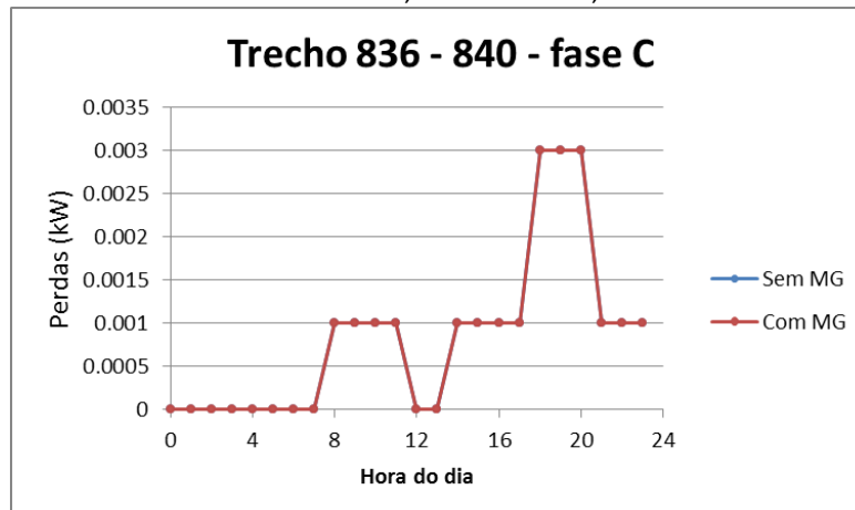
Figura 39 - Perdas no trecho 836 - 840, com e sem GD, na fase C durante 24 horas.
