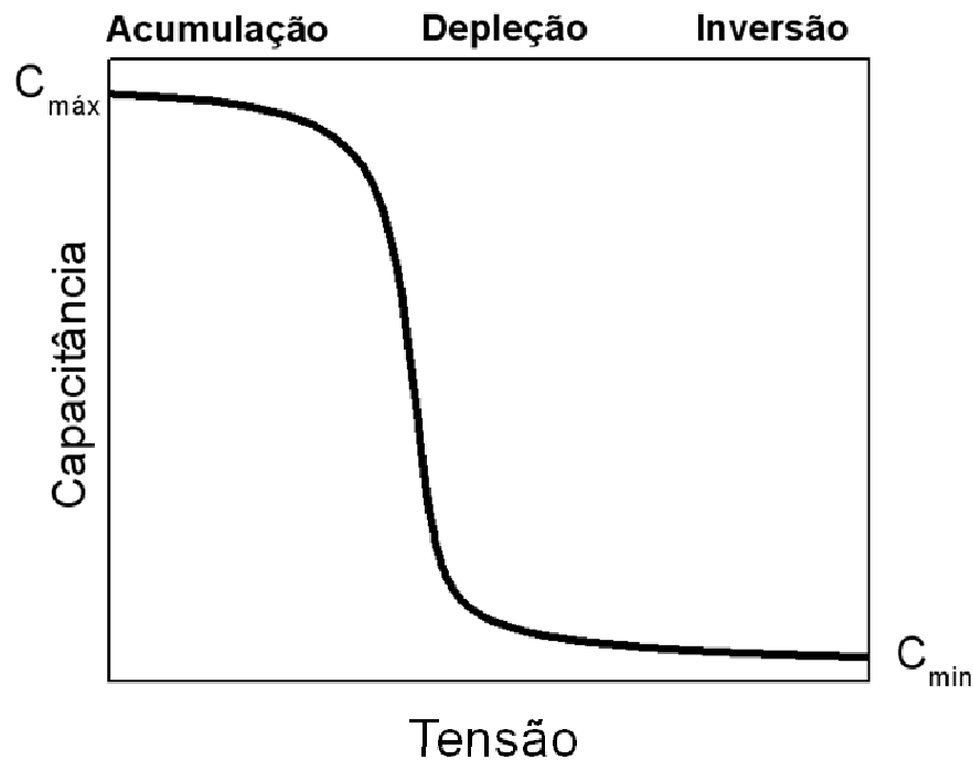
Figura 2.23: Curva C-V típica de uma estrutura MOS ideal (livre de defeitos), com um semicondutor tipo- p .
