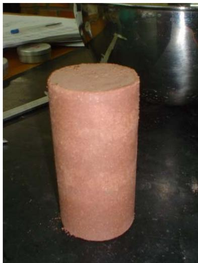
Figura 5.1: corpo-de-prova de solo-cimento
