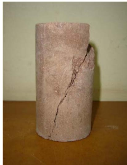
Figura 6.19b: plano de ruptura típico
