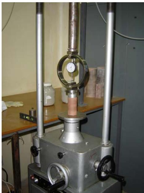
Figura 5.2: ensaio de resistência à compressão simples
