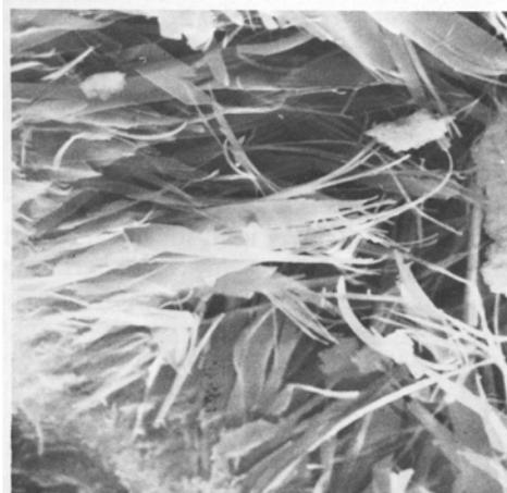
Figura 7.1: fotomicrografia da pasta de cimento Portland endurecida (INGLES & METCALF, 1972)
