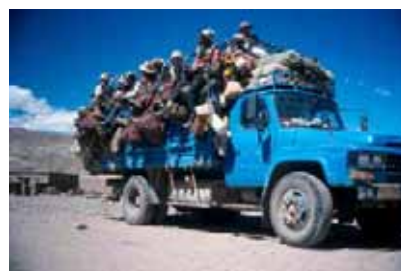
Figura explicativa do acondicionamento inadequado das cargas
