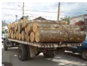
Figura explicativa do acondicionamento inadequado das cargas
