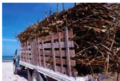
Figura explicativa do acondicionamento inadequado das cargas
