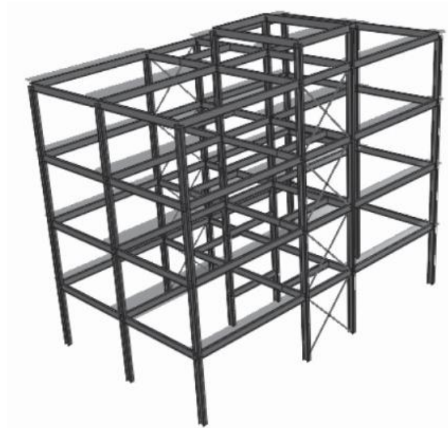
Figura 20 – Perspectiva da estrutura de aço do edifício
