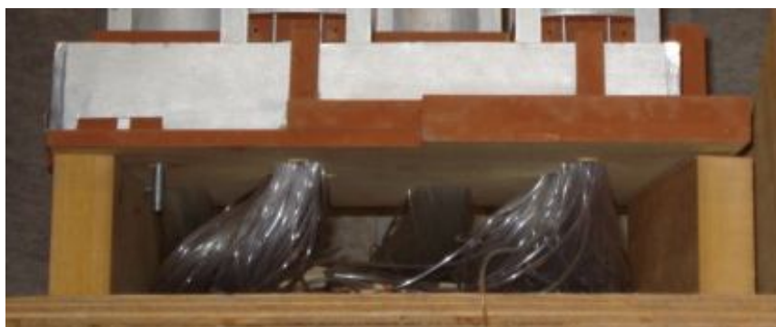
Figura 42: medidores de Pressão em modelo de túnel de vento
