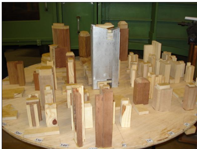
Figura 41: exemplo de modelo ensaiado em túnel de vento
