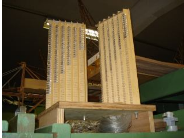
Figura A1: exemplo de modelo ensaiado em túnel de vento
