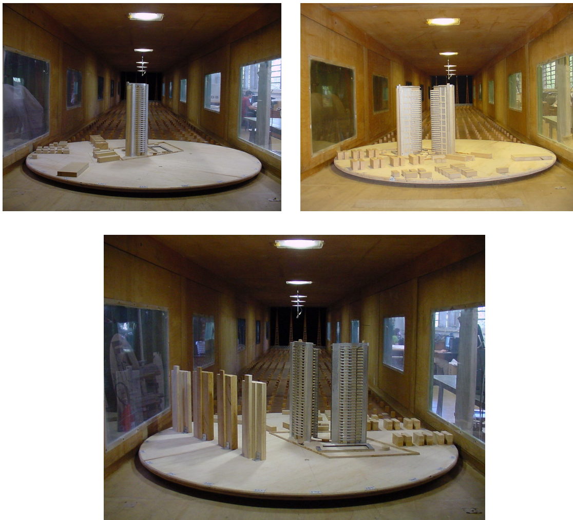
Figura 59: modelo de ensaio para túnel de vento para a configuração I (superior, à esquerda), configuração II (superior, à direita) e configuração III (inferior)
