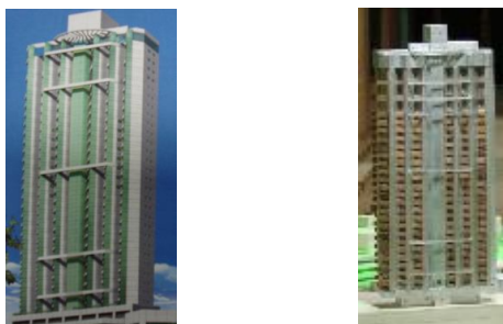
Figura 39: exemplo da perspectiva de um edifício e seu modelo para ensaio
