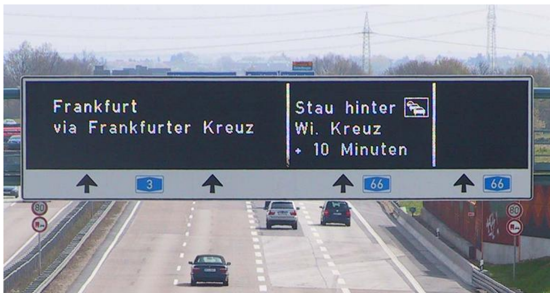
Figura 2 – Painel de mensagem variável, na Alemanha, alertando sobre o congestionamento e fornecendo informações sobre rotas e duração de viagem.
