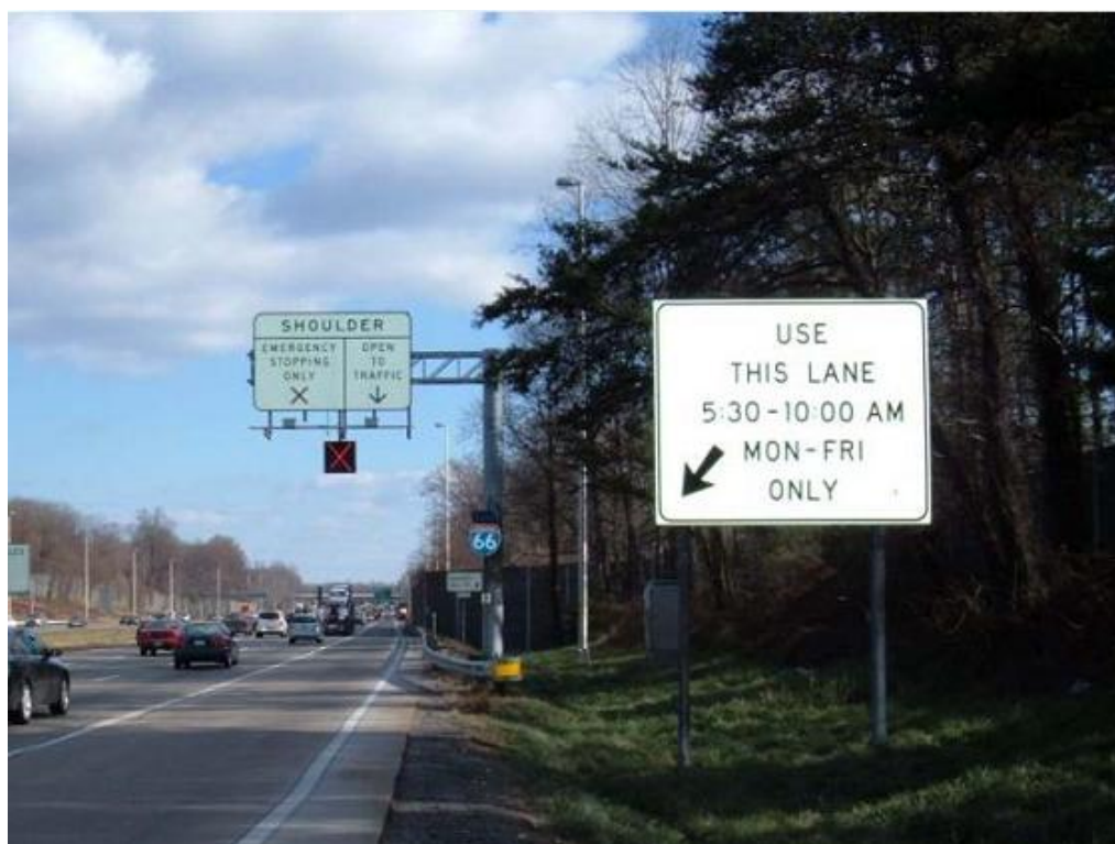
Figura 8 – Utilização do acostamento em horários fixos nos Estados Unidos
