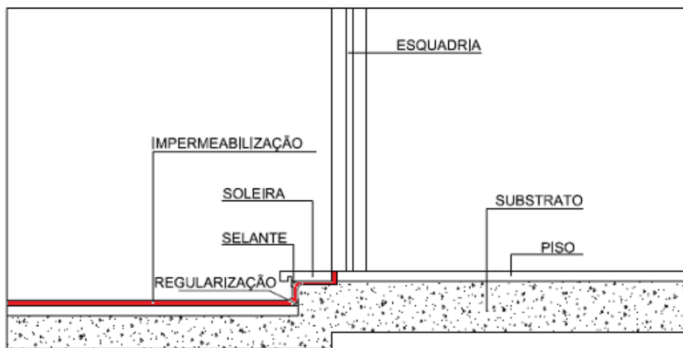
Figura 34 – Representação gráfica de ancoragem com a retirada da soleira
