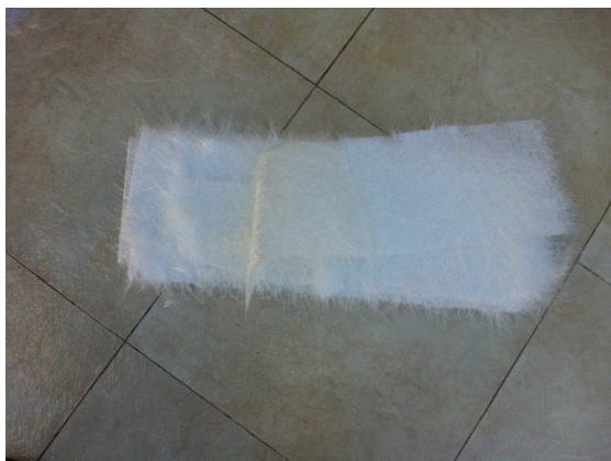
Figura 18 – Véu de fibra de vidro recortado para uso em rodapé
