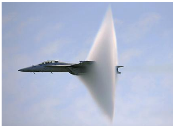
Figura 1: avião supersônico rompendo a barreira do som.
