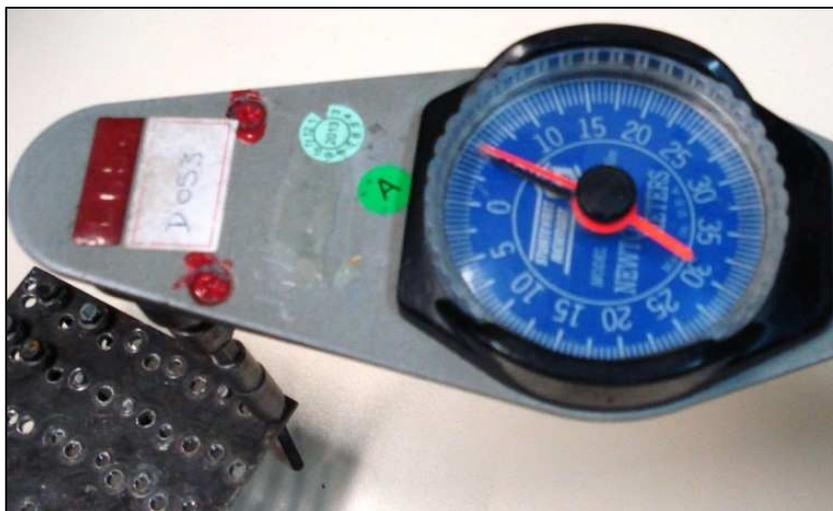
Figura 10 – Ensaio de torque de fragilização por hidrogênio dos parafusos
