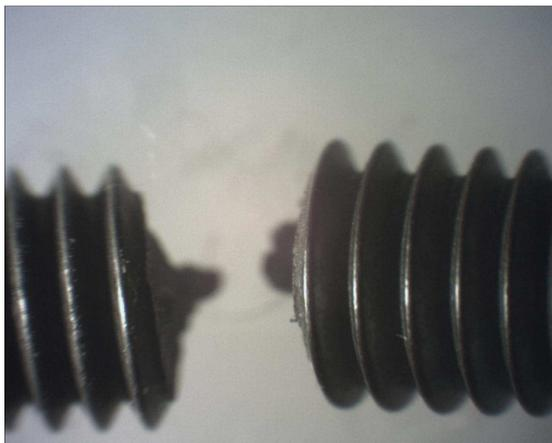
Figura 17 – Imagem do local da fratura na raiz da rosca (vale) ocorrida no ensaio de tração.
