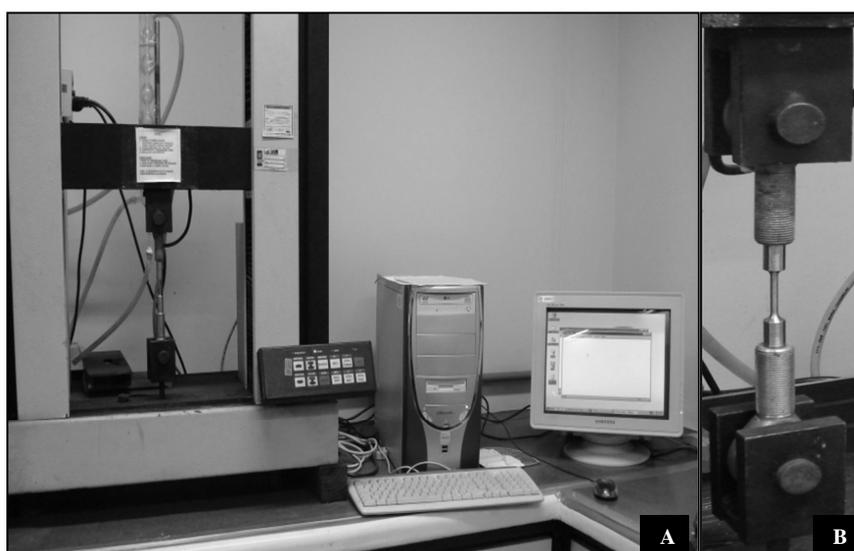
Figura 9 – A) Máquina de ensaio de tração utilizada no trabalho B) corpo de prova em tração
