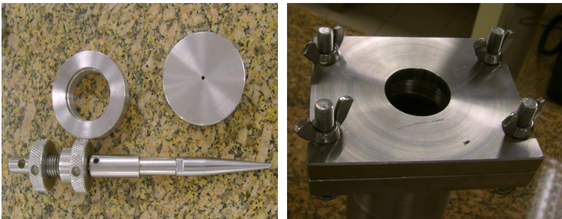
Figura 7: Ponteira, acessórios de fixação e base para teste de perfuração
