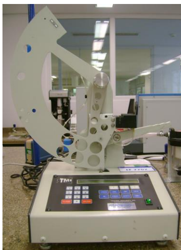
Figura 8: Pêndulo para medida da Resistência ao Rasgo Elmendorf
