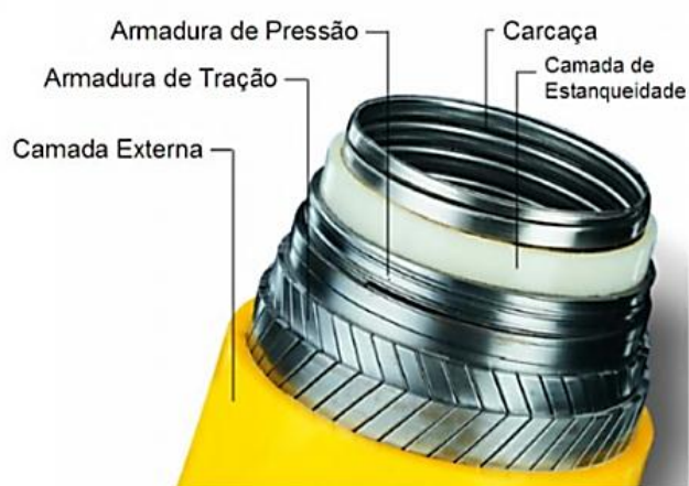
Figura 2.20 Conceção típica de um duto flexível de camada não aderentes (RUBIN 2006).
