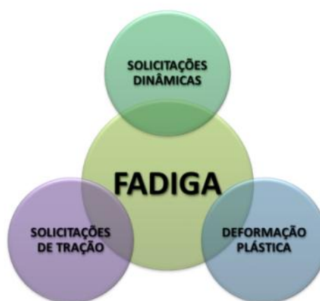
Figura 2.1 Representação esquemática dos três fatores necessários para que aconteçam falhas por fadiga em materiais metálicos.
