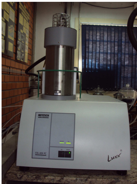
Figura 22. Termobalança Netzsch 409 PC Luxx empregada nos ensaios de TGA.
