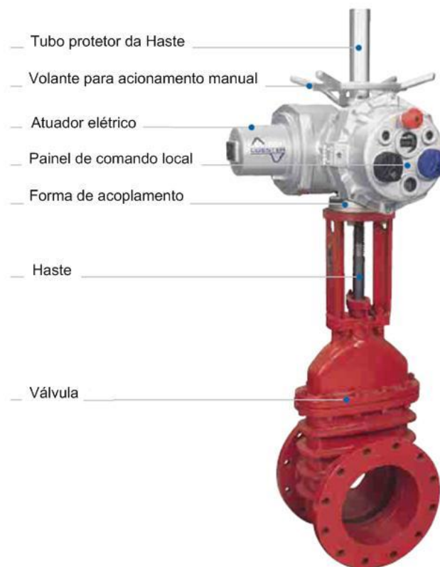
Figura 14 Conjunto atuador-válvula
