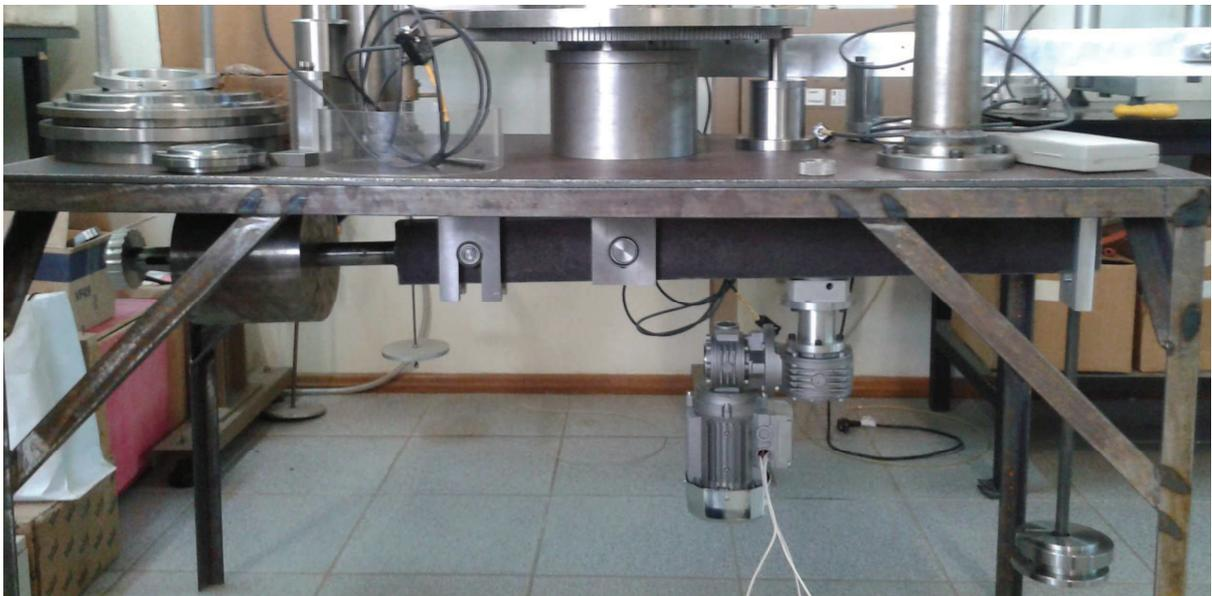
Figura 41. Visão geral do sistema de carregamento vertical do equipamento *ring shear*.
