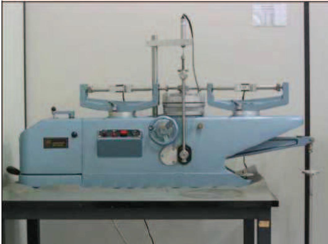
Figura 29. Visão geral do equipamento *ring shear* de Bromhead, 1979 (RIGO, 2005).
