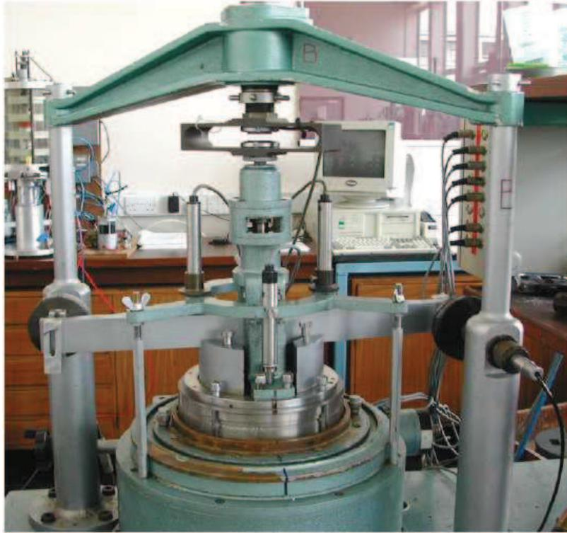
Figura 25. Visão geral do equipamento *ring shear* de Bishop *et al.* (1971) (CASAGRANDE, 2005).
