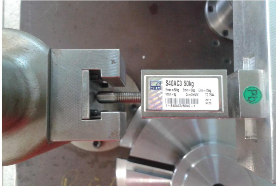
Figura 44. Pino e apoio deslizante da célula de carga.
