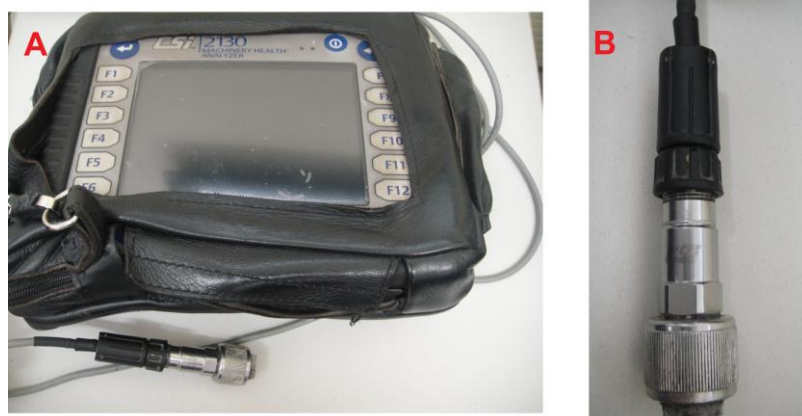
Figura 4.2.1 – A - Coletor de dados da marca Emerson CSI 2130 e B - Acelerômetro Piezoelétrico, utilizados nas coletas de dados.
