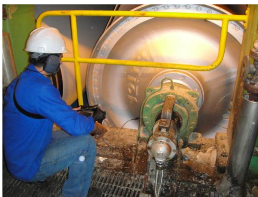
Figura 4.3.1 - Técnico especializado realizando a medição de vibrações no cilindro secador 028.
