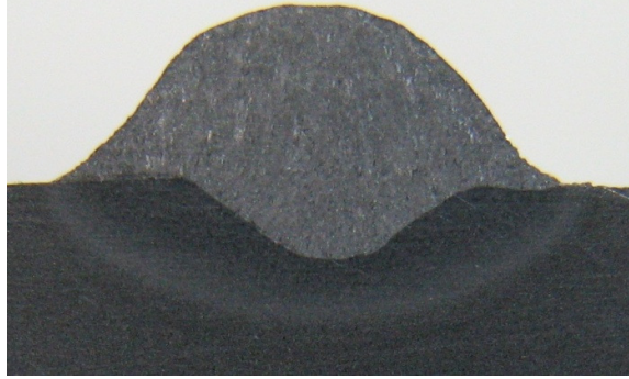
Figura A.23 – Macrografia do cordão de solda 23
