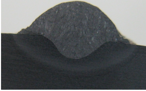
Figura A.21 – Macrografia do cordão de solda 21
