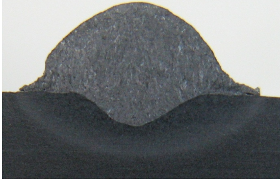
Figura A.3 – Macrografia do cordão de solda 3
