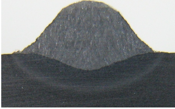
Figura A.7 – Macrografia do cordão de solda 7
