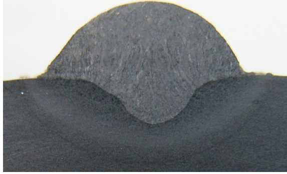
Figura A.15 – Macrografia do cordão de solda 15
