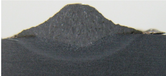
Figura A.4 – Macrografia do cordão de solda 4
