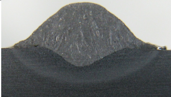
Figura A.20 – Macrografia do cordão de solda 20
