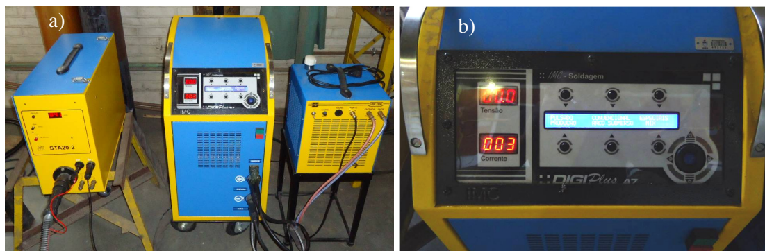
Figura 3.3 – (a) Fonte de soldagem IMC Digiplus A7 450 e (b) detalhe da IHM da fonte de soldagem
