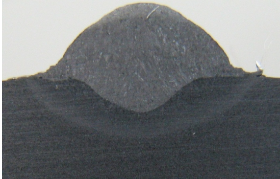
Figura A.32 – Macrografia do cordão de solda 32
