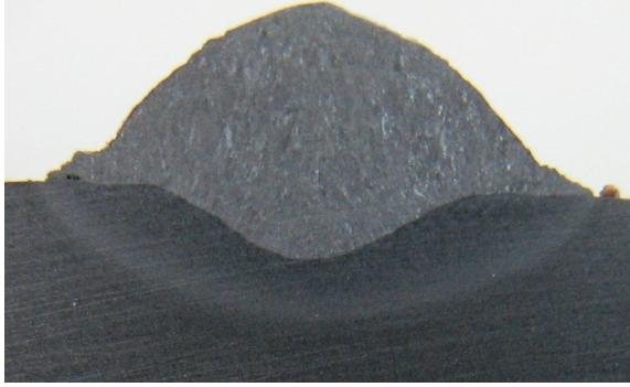
Figura A.11 – Macrografia do cordão de solda 11
