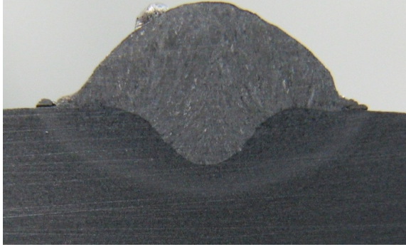
Figura A.31 – Macrografia do cordão de solda 31
