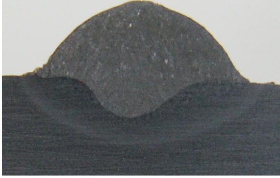
Figura A.19 – Macrografia do cordão de solda 19
