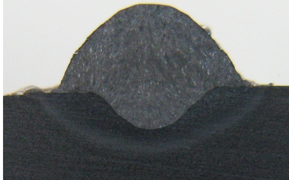
Figura A.1 – Macrografia do cordão de solda 1
