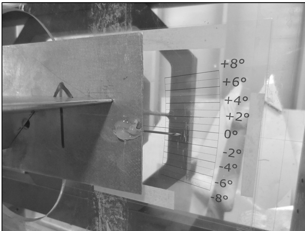
Figura C.7: Agulha e gabarito para marcação dos ângulos
