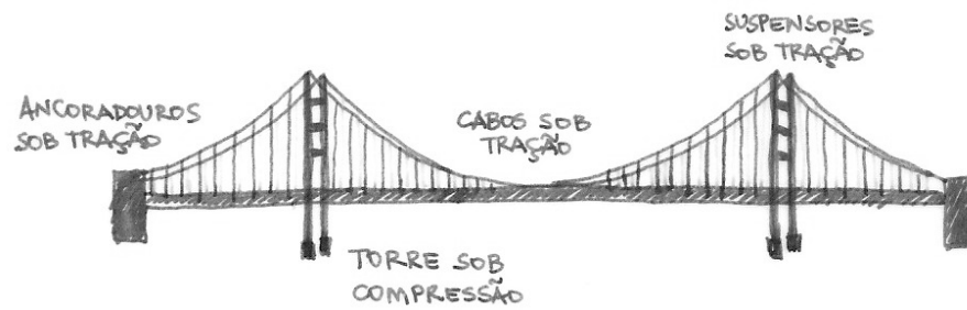
Figura 2.2: Esquema geral das forças exercidas numa ponte suspensa
