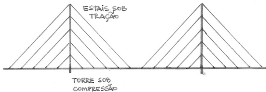
Figura 2.3: Esquema geral de forças em uma ponte estaiada
