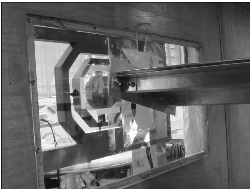
Figura C.15: Modelo II instalado na balança
