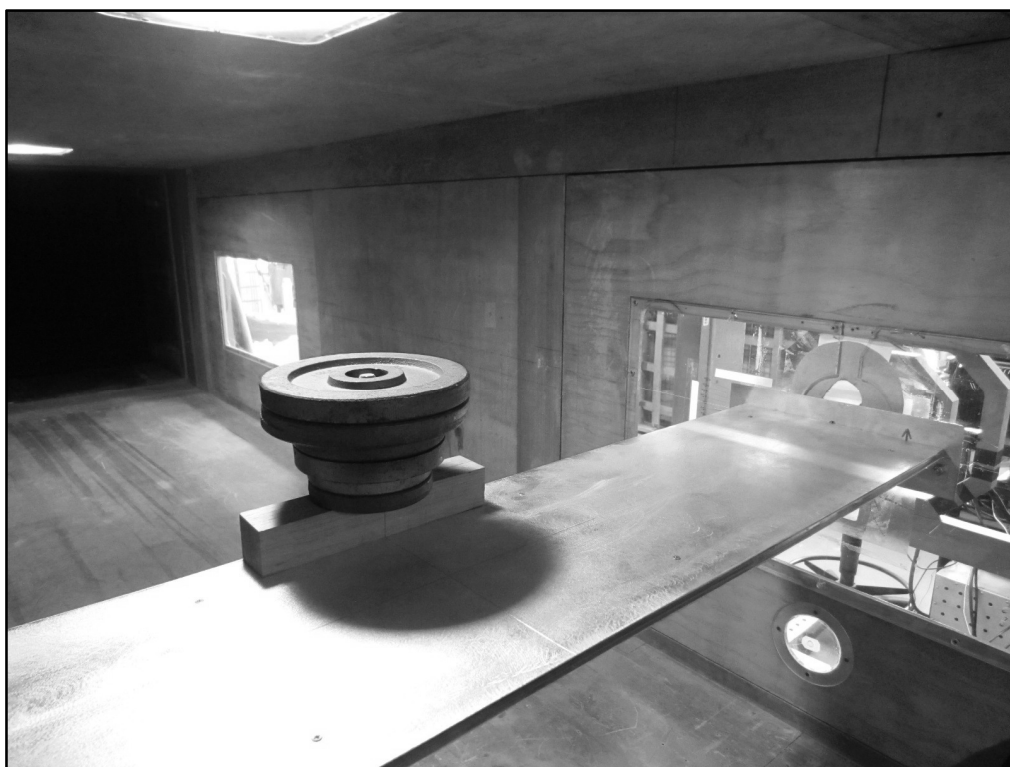
Figura C.10: Calibração do modelo – torção
