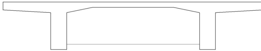
Figura 3.3: Seção com duas vigas "T"
