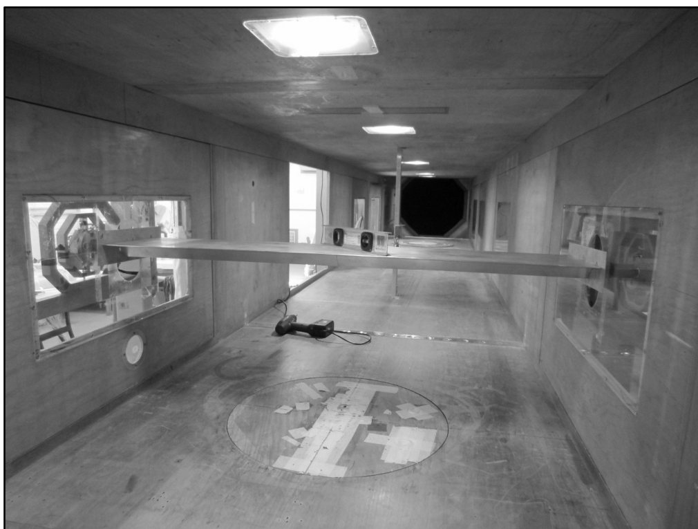
Figura C.14: Fixação do modelo no túnel
