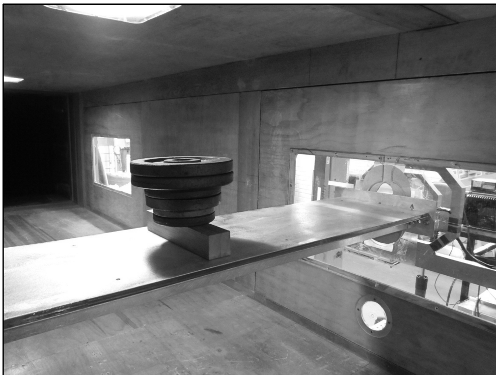
Figura C.9: Calibração do modelo - força vertical
