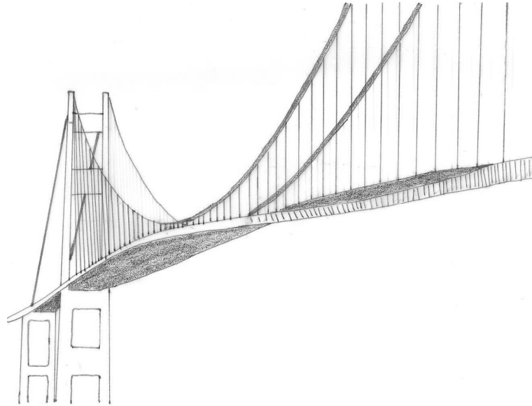
Figura 1.2: Movimento combinado de flexão e torção no vão central da ponte Tacoma Narrows
