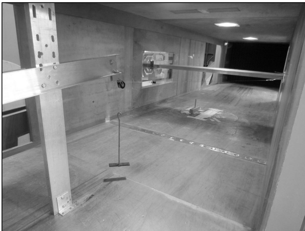
Figura C.8: Calibração - força horizontal
