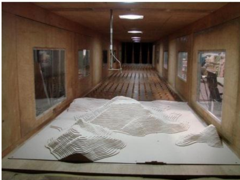
Figura 4.1 – Modelo reduzido do Morro do Jaburu, no ensaio no Túnel de Vento [LAC,2010]
