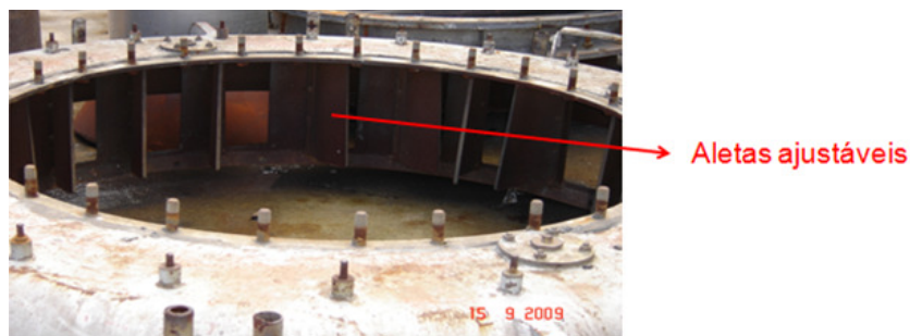
Figura 3.2 – Aletas ajustáveis que configuram o classificador de um moinho a carvão
