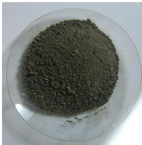
**Figura 31: Agregado miúdo reciclado de rejeitos de carvão.**
