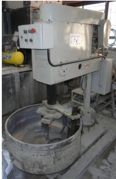
**Figura 21: Betoneira de eixo vertical utilizada na produção do concreto.**
