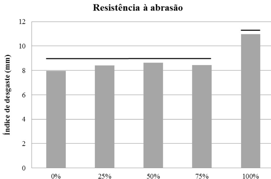
**Figura 41: Gráfico de barras indicando o índice de desgaste por abrasão médio obtido para cada porcentagem de substituição.**
