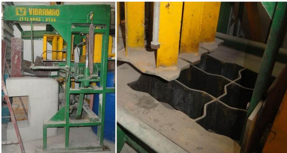
**Figura 22: Visão lateral da vibro-prensa e detalhe dos moldes.**
