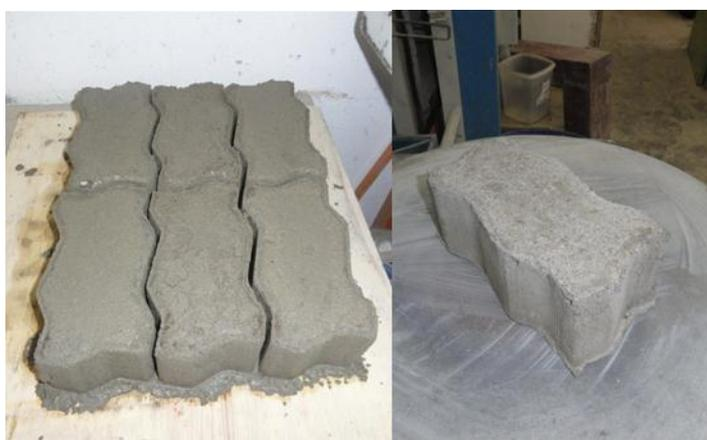
**Figura 23: Blocos de concreto obtidos com o segundo traço utilizado (estado fresco e endurecido).**
