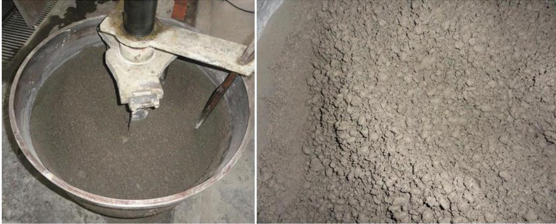
**Figura 43: Formação de grumos durante a mistura dos materiais.**
