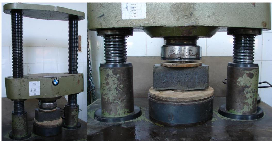
**Figura 25: Detalhes do ensaio de resistência à compressão.**
