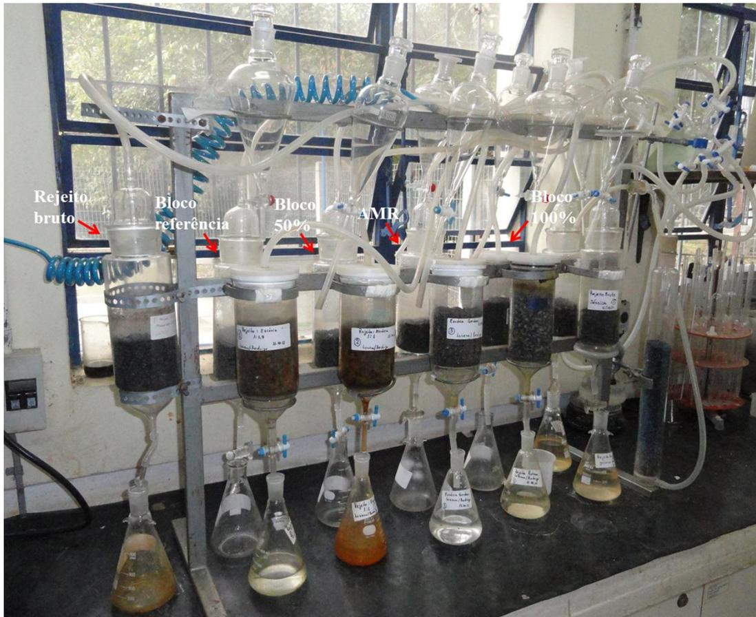
**Figura 27:** Células úmidas utilizadas para realização dos ensaios cinéticos de previsão da drenagem ácida de mina.
