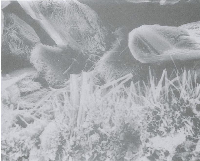
**Figura 12: Digitalização de uma fotomicrografia eletrônica de ataque interno por sulfato em concreto da região do Golfo Árabe (Hewlett, 2003) .**
