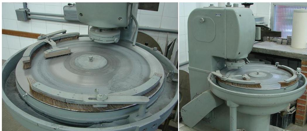
**Figura 26: Equipamento utilizado no ensaio de resistência à abrasão.**
