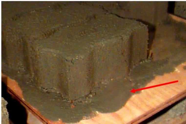
**Figura 9: Bloco obtido a partir de concreto produzido com excesso de água (Pagnussat, 2004).**
