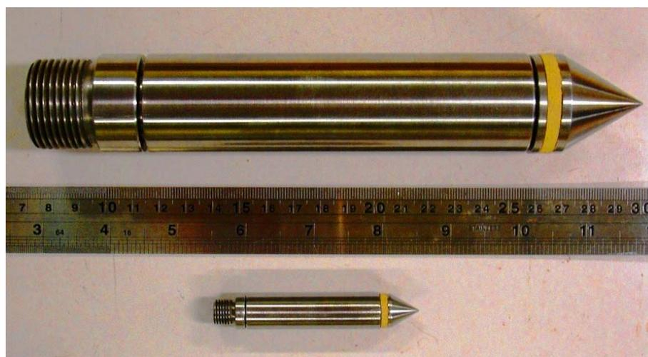
Figura 3.13 – Comparação entre o tamanho real e o tamanho da ponteira utilizada nos ensaios
