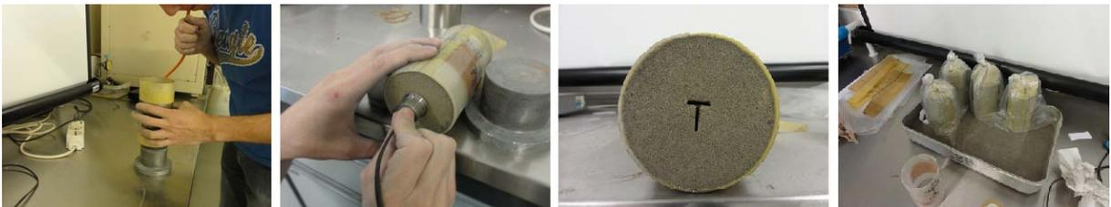
Figura 4.5 – Procedimento adotado para os corpos de prova submetidos a medidas de rigidez
