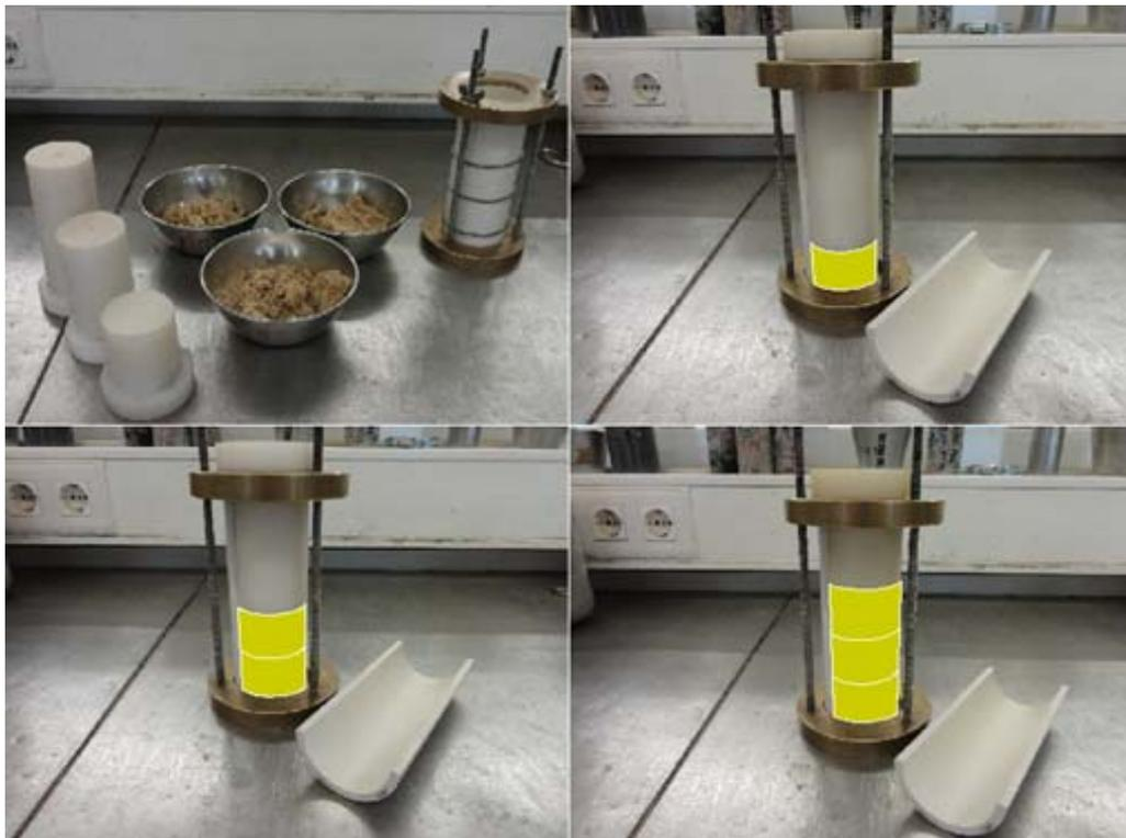
Figura 4.3 – Sequência de moldagem e materiais utilizados para as amostras sem cimento
