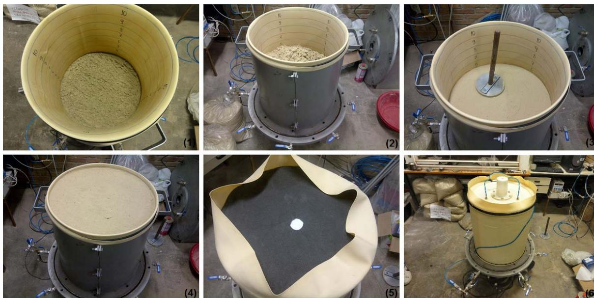
Figura 4.6 – Sequência de moldagem dos CPs de 500x500 mm
