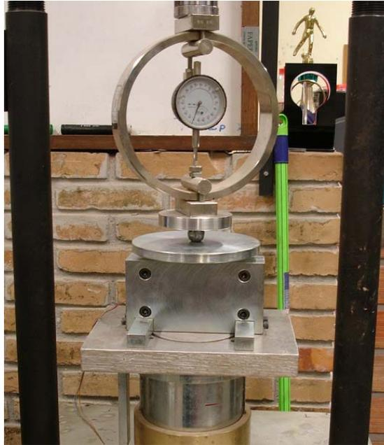
Figura 3.18 – Calibração da célula de carga de ponta do mini CPT
