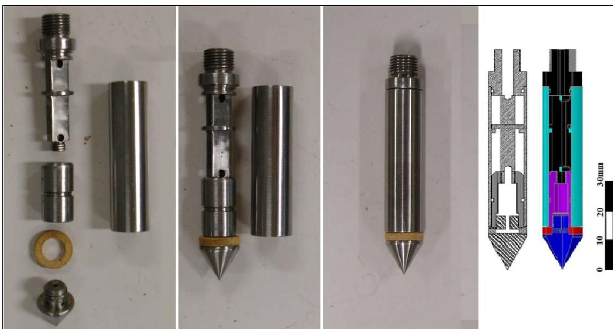
Figura 3.16 – Ponteira do mini CPT
