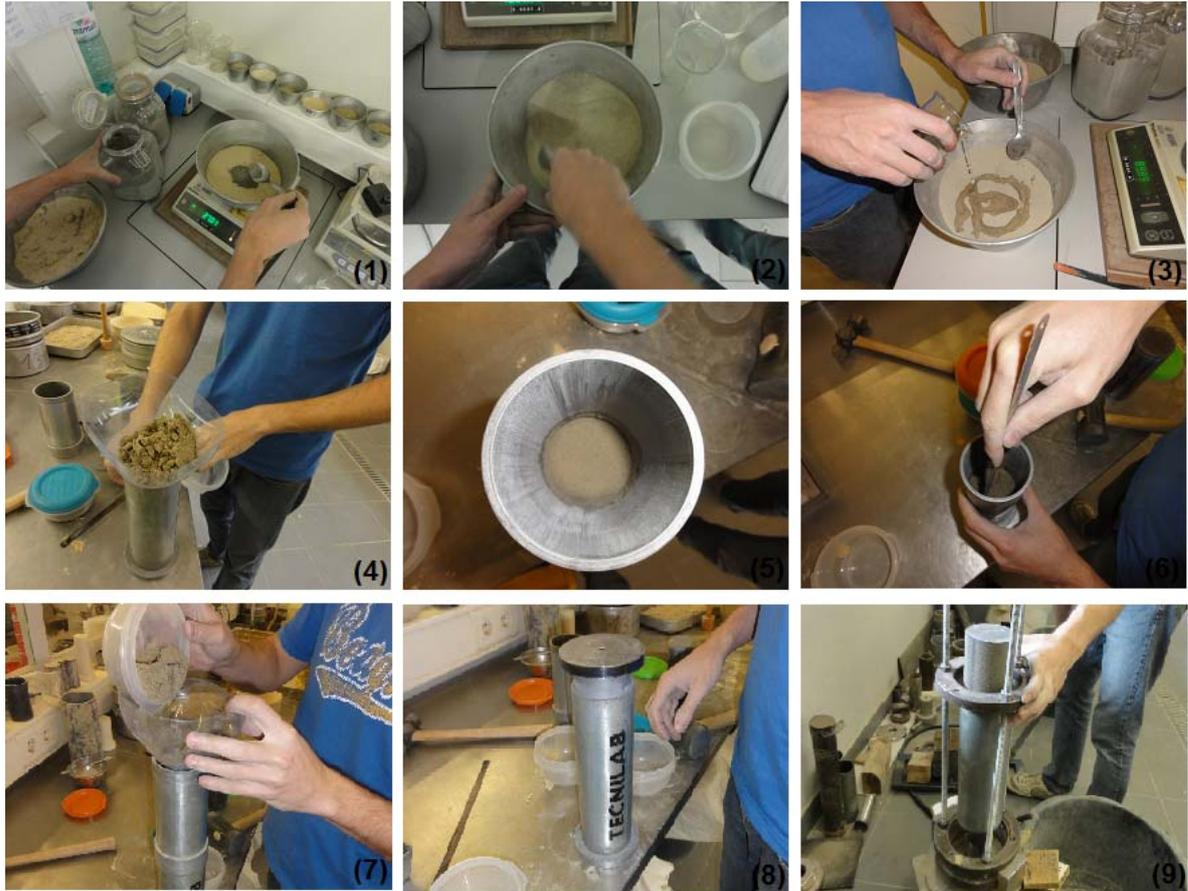
Figura 4.4 – Sequência de moldagem adotada
