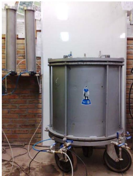
Figura 3.11 – Interfaces ar-água e câmara triaxial
